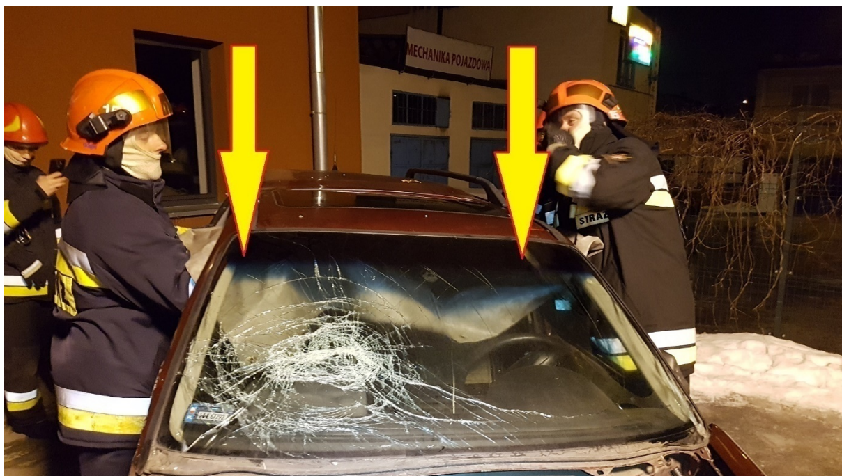
Rys. 191. Umieszczenie płachty pod szyberdachem, w poprzek pojazdu przez dwóch ratowników
