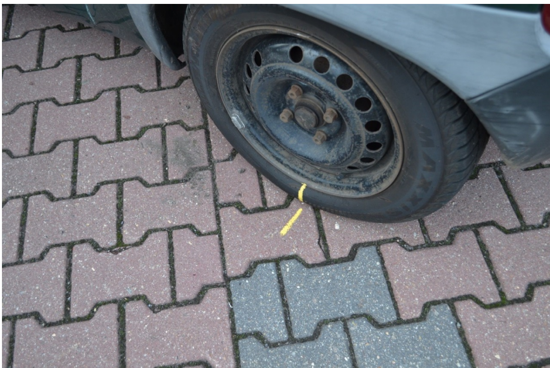
Rys. 367. Zaznaczenie, które pozwala ocenić brak ruchu w osi pojazdów
