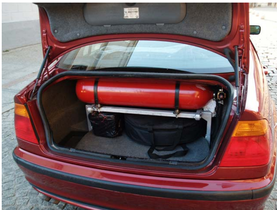
Rys. 75. Zbiornik CNG w bagażniku auta
