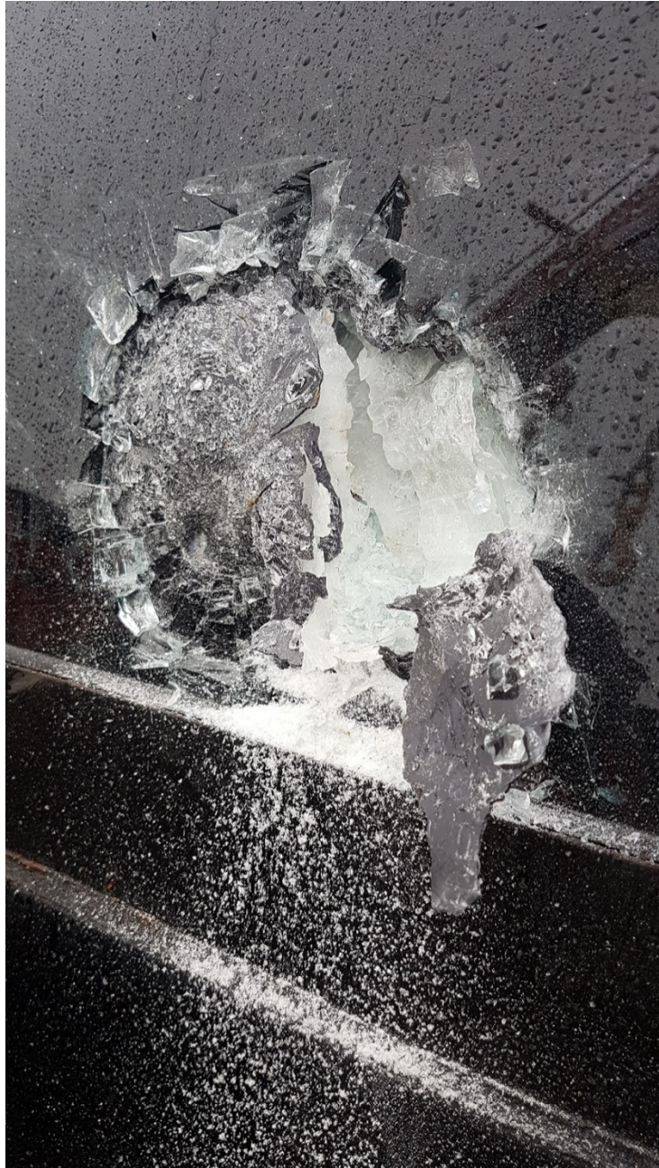
Rys. 461. Efekt kilkunastu uderzeń młotem 5 kg
