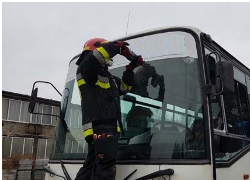
Rys. 398. Cięcie przedniej szyby klejonej przy pomocy piły szablonej
