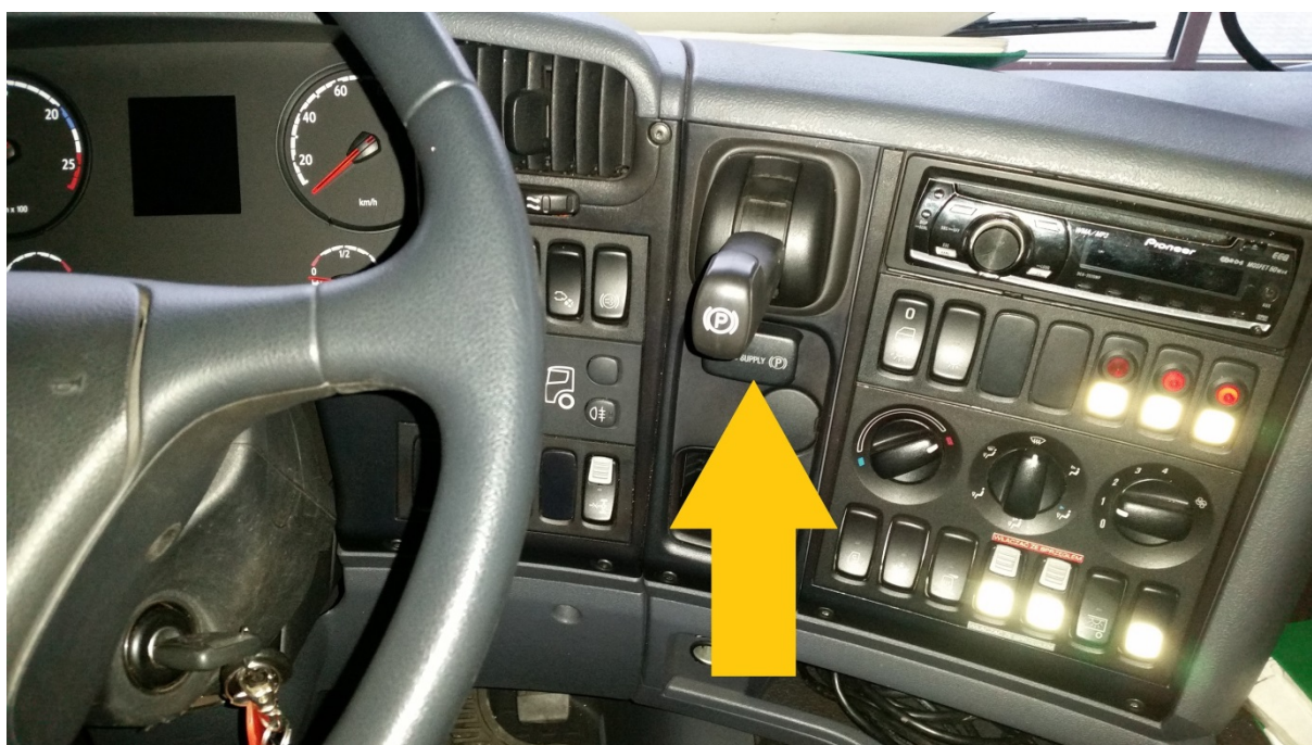
Rys. 103. Dźwignia hamulca postojowego na desce rozdzielczej
