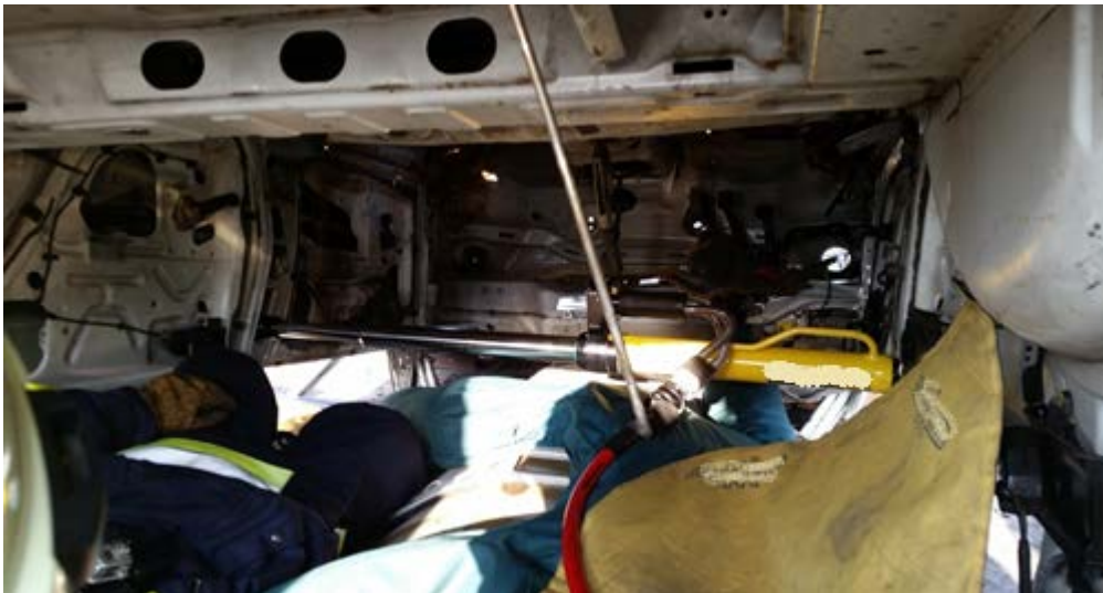
Rys. 307. Technika cross-ramming w pojeździe na dachu
