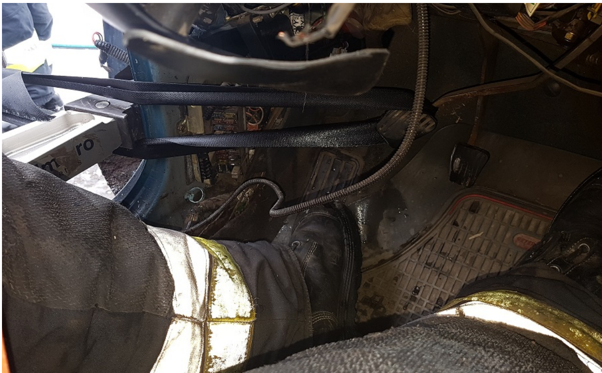
Rys. 217. Odgięcie pedałów przy pomocy taśmy wykonanej z pasa bezpieczeństwa i rozpieracza osadzonego o podstawę słupka B (widok wewnątrz)
