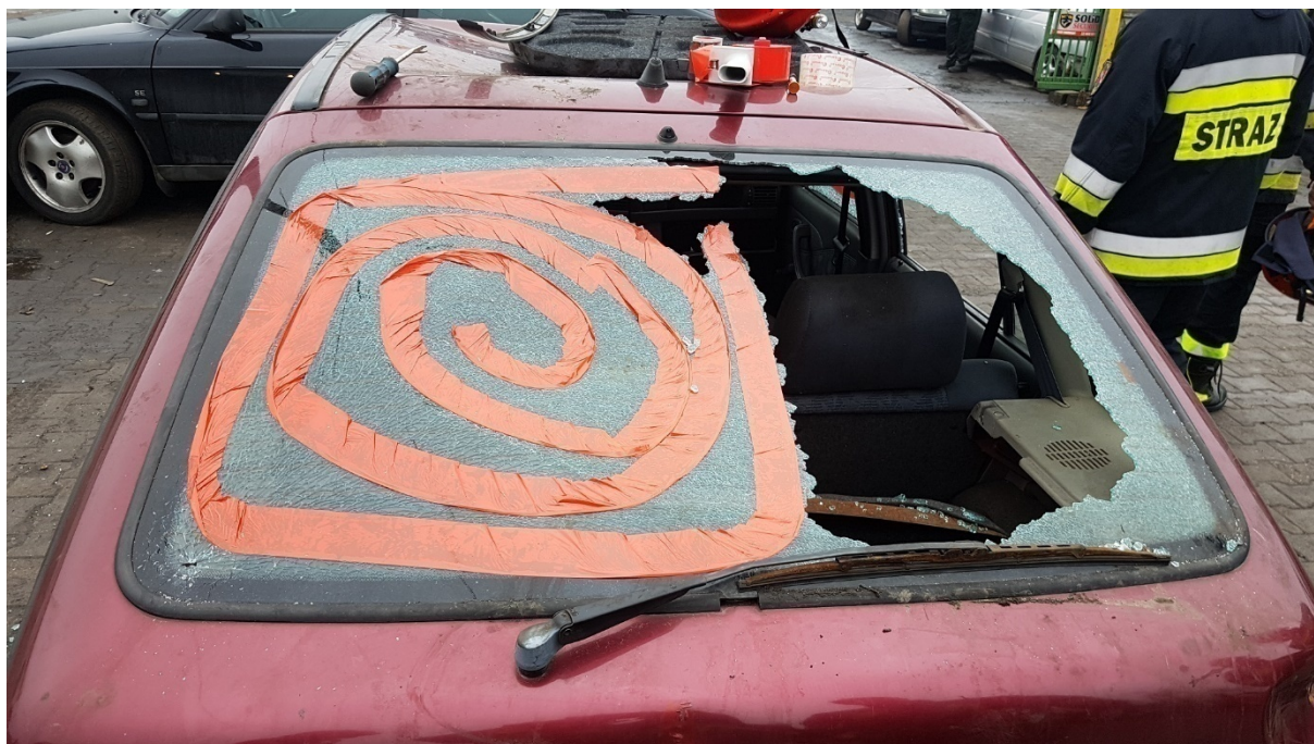
Rys. 188. Oklejenie tylnej szyby w połowie dla pokazania zalet techniki
