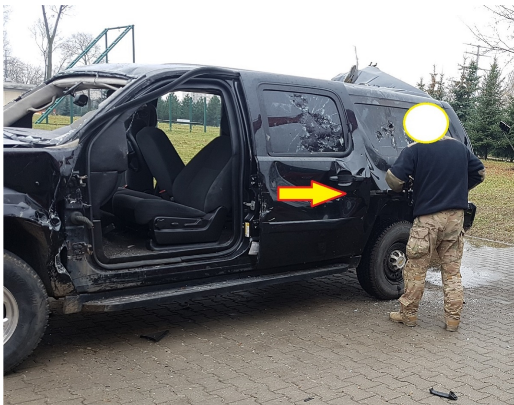
Rys. 458. Wyważenie drzwi od strony zamka
