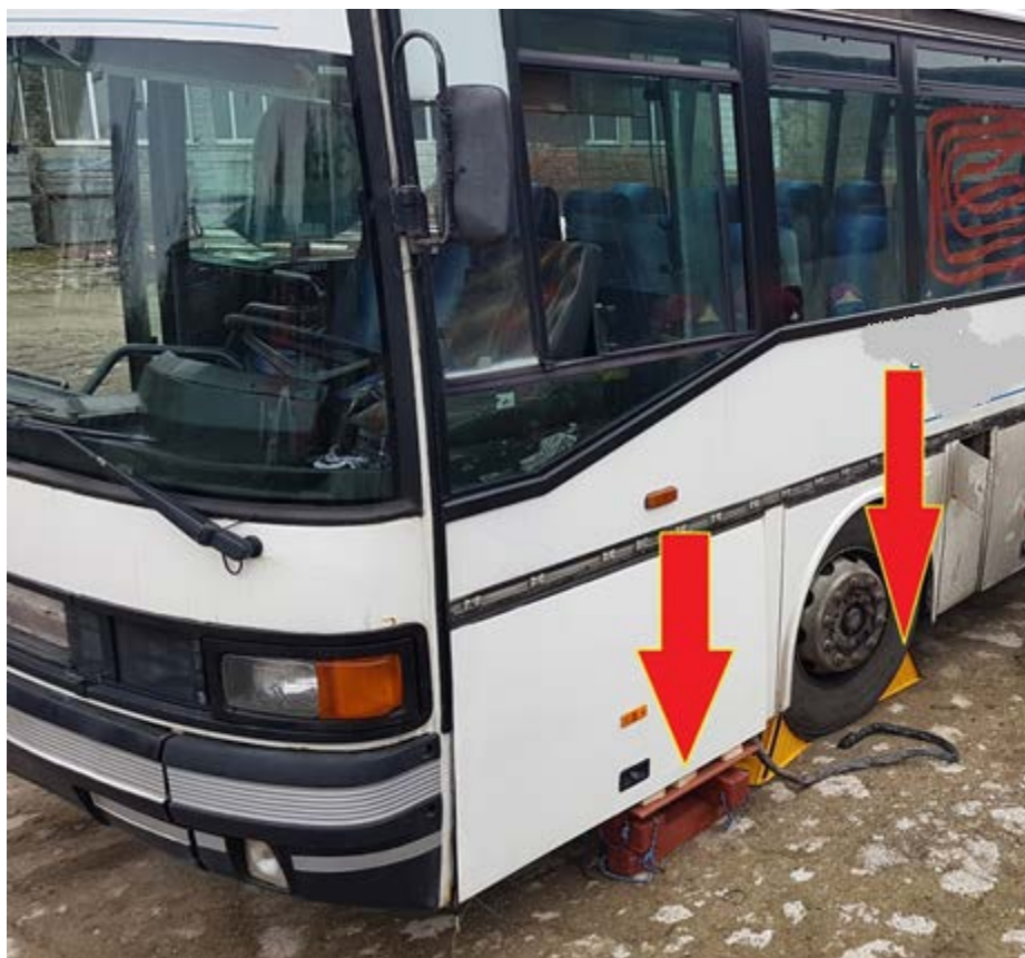
Rys. 392. Stabilizacja autobusu podbudową z drewna oraz zabezpieczenie przed toczeniem przy pomocy klinów pod koła
