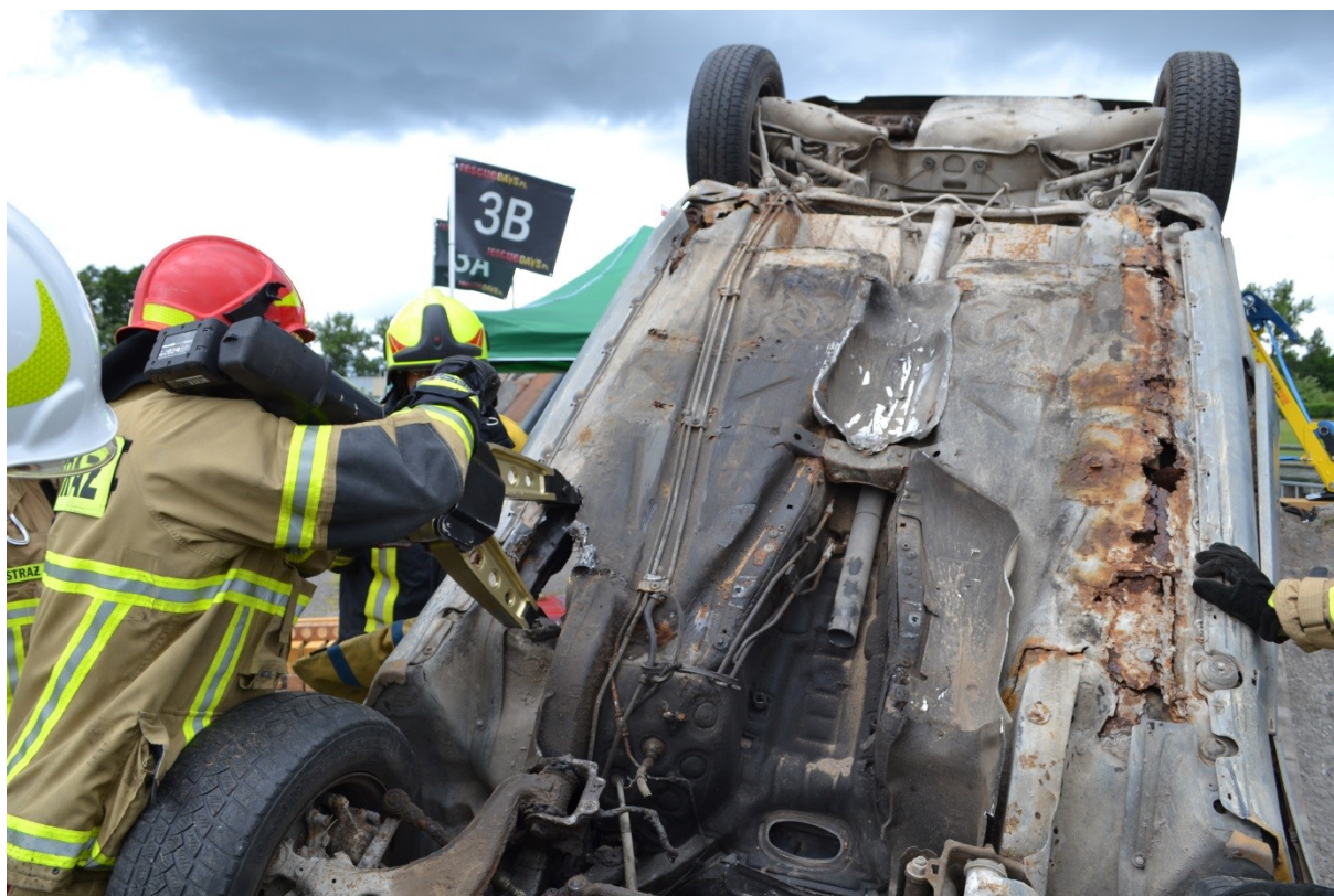
Rys. 224. Wykonanie otworu w podłodze, gdy pojazd leży na dachu
