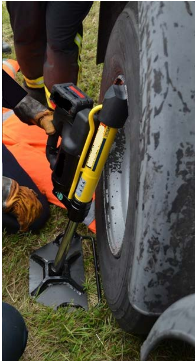
Rys. 382. Podnoszenie koła cylindrem rozpierającym po zastosowaniu końcówki do felg wklęsłych
