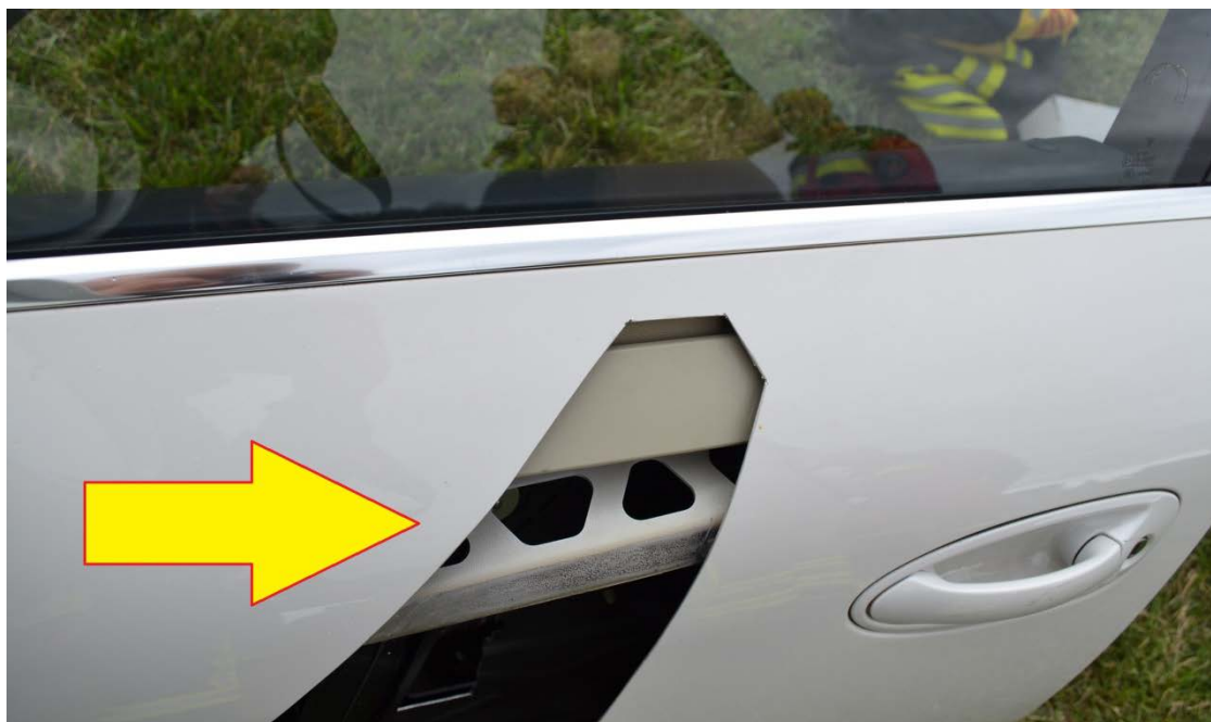
Rys. 135. Widoczne wzmocnienie drzwi
