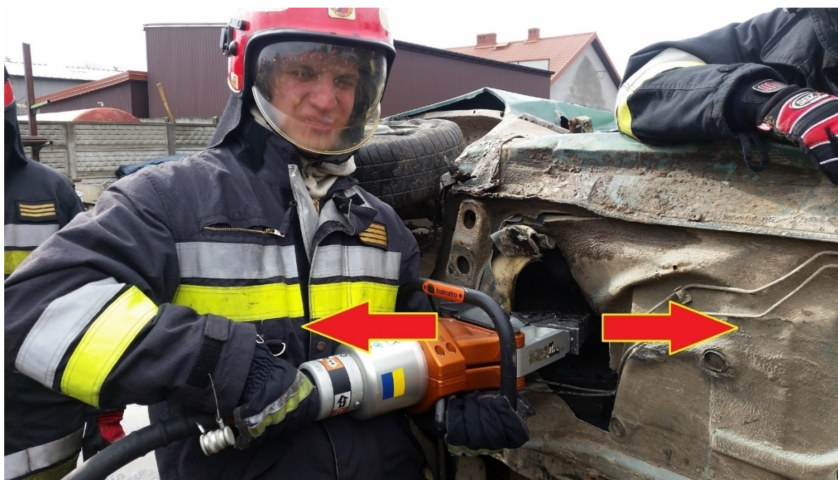
Rys. 222. Wykonanie otworu w podłodze rozpieraczem. Drugi ruch jest zawsze prostopadły do pierwszego
