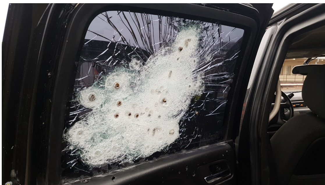
Rys. 452. Szyba boczna, wytrzymała ostrzał z broni palnej
