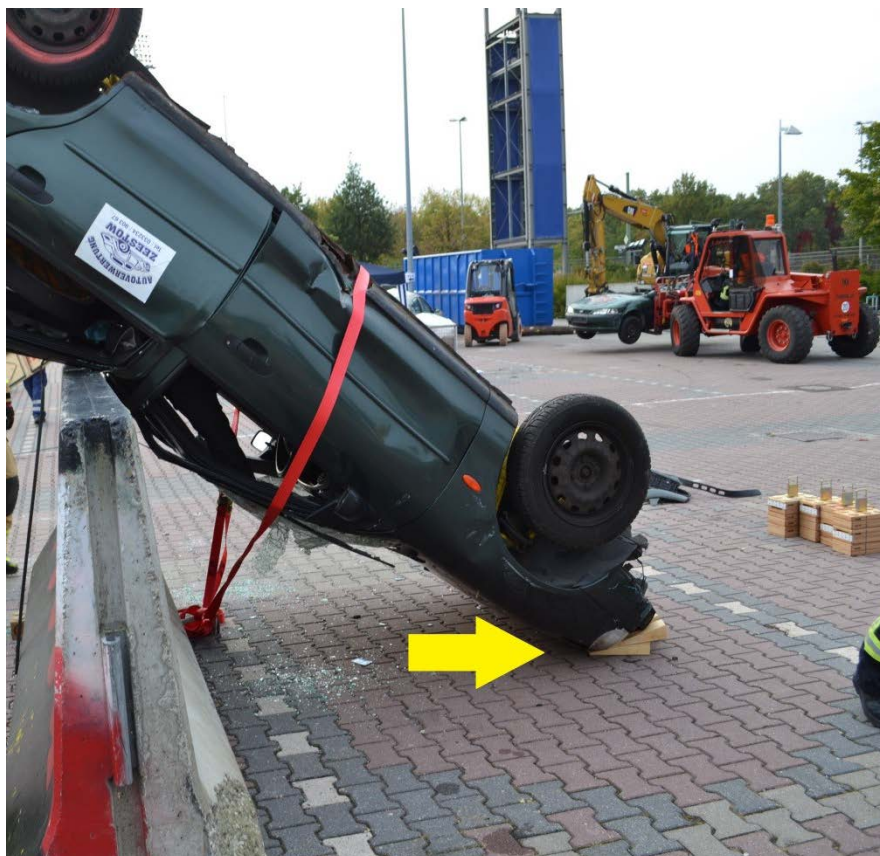
Rys. 314. Stabilizacja pojazdu przy pomocy halligana i pasa transportowego z naciągami. Tu widoczne również klinowanie, które zabezpiecza przed ruchem w osi
