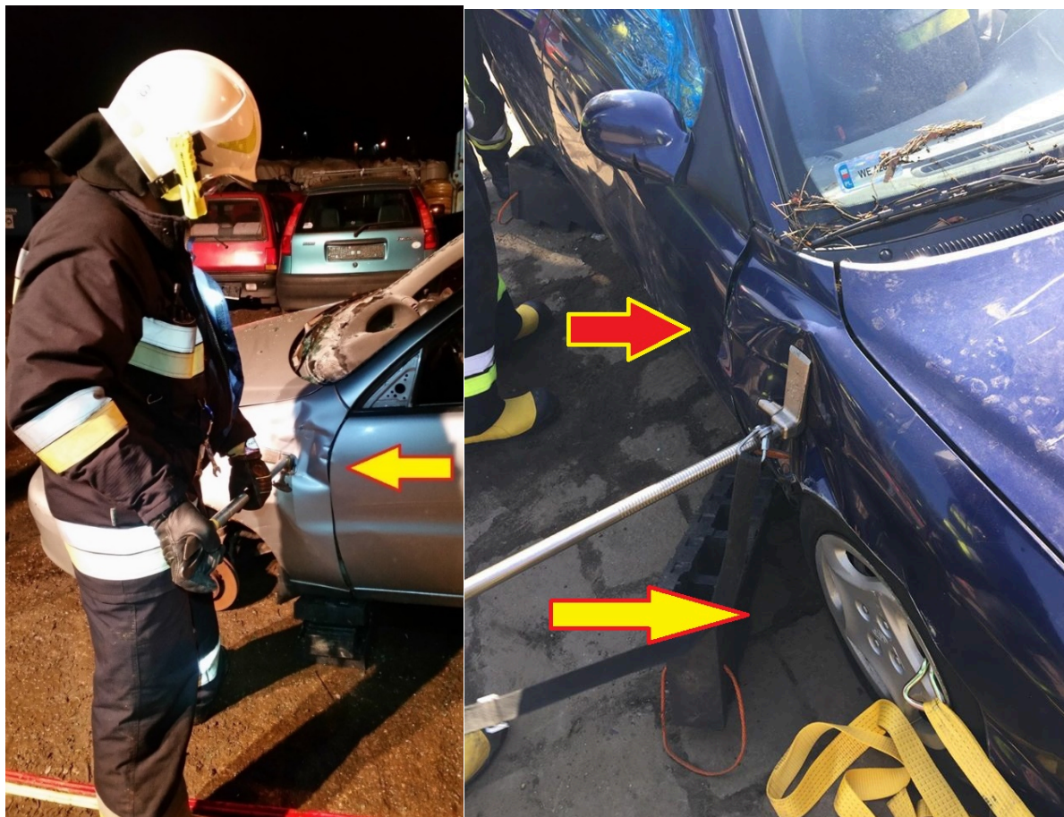
Rys.247 A, B .Wykonanie szczeliny przy pomocy halligana, poprzez wejście w otwór po kierunkowskazie
