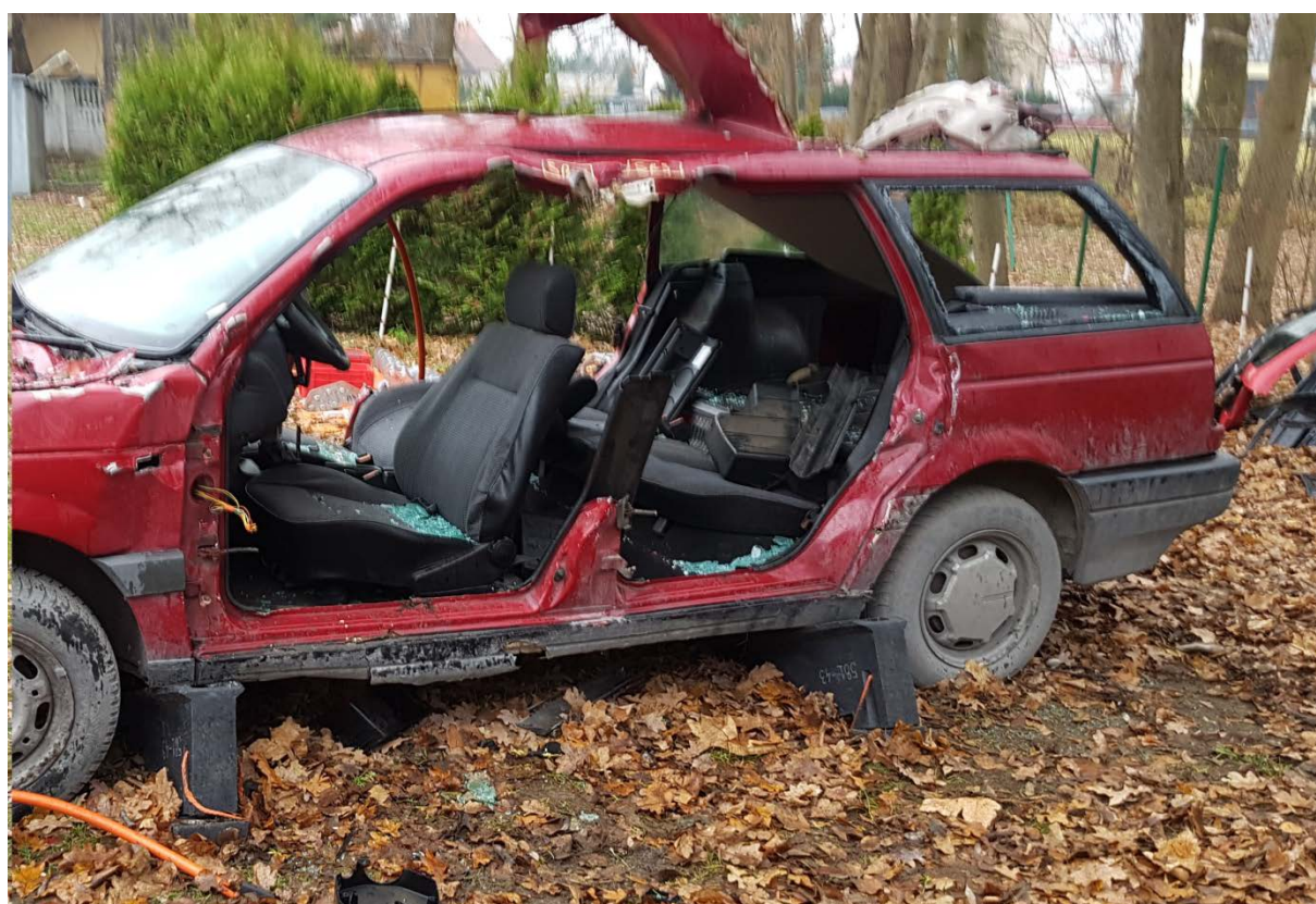
Rys. 258. Przestrzeń uzyskana po usunięciu boku pojazdu
