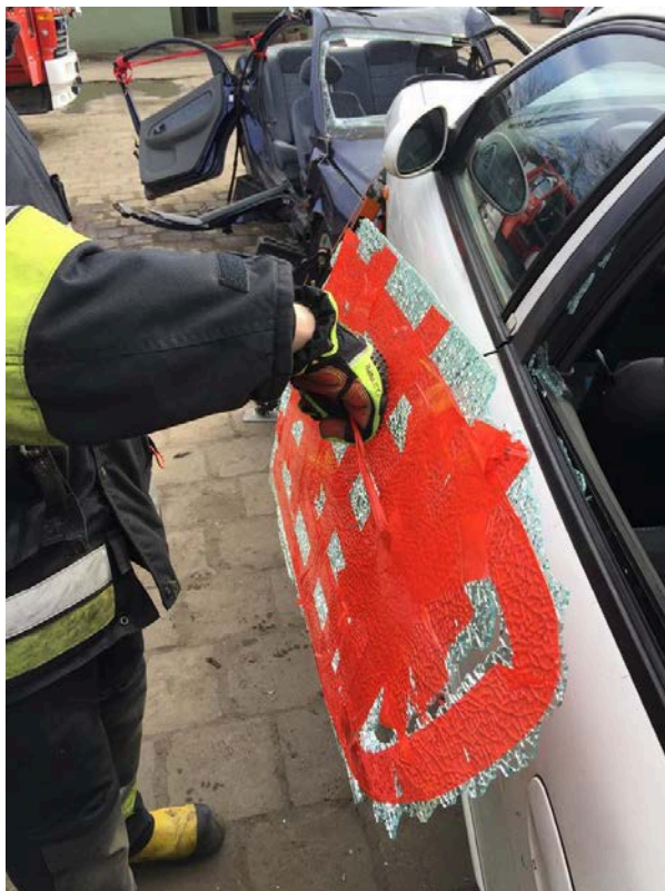
Rys. 189 A, B, C. Wykonanie uchwytu z taśmy podczas oklejania, które umożliwia wyciągnięcie rozbitej szyby hartowanej do zewnątrz
