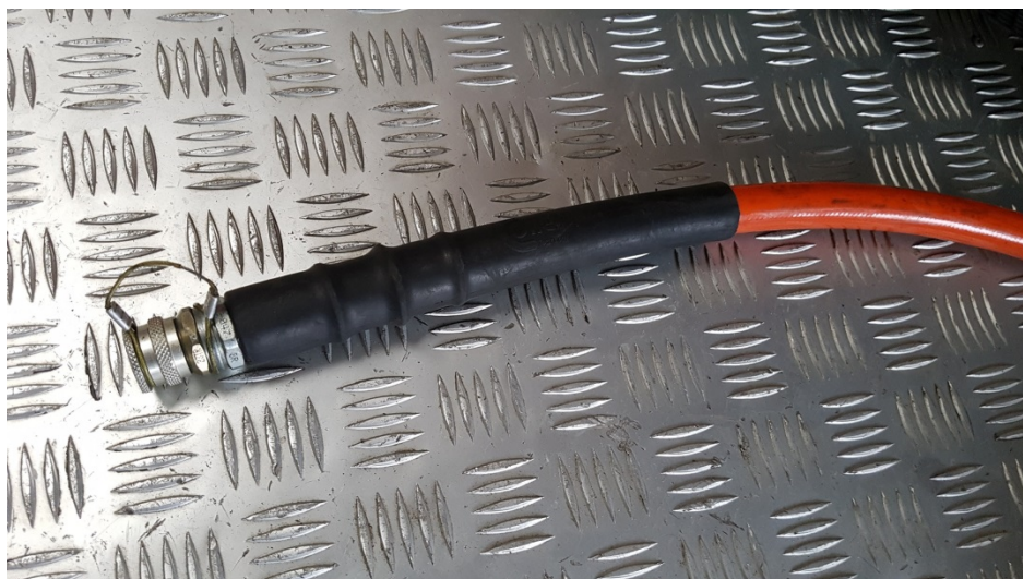
Rys. 26. Zestaw węża z szybkozłączem – jedno z rozwiązań
