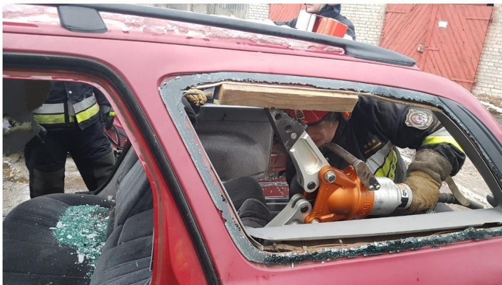
Rys. 281 A, B. Siłowe opuszczenie tylnego oparcia rozpieraczem z wnętrza. W ten sam sposób można opuścić przednie siedzenie.
