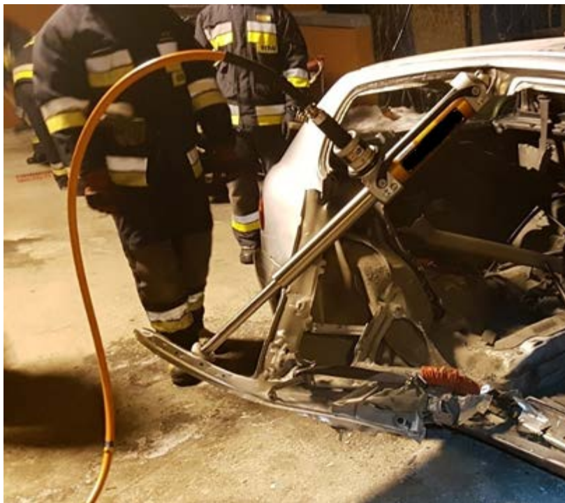
Rys. 273. Metoda „trzech drzwi”. Odgięcie poszycia przy pomocy cylindra rozpierającego
