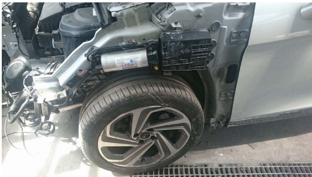
Rys. 131. Kondensator energii systemu START/STOP Źródło: Emil Olędzki SGSP
