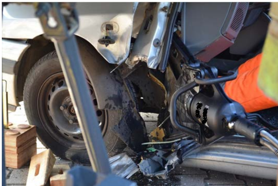
Rys. 363. Wyparcie nacięcia rozpieraczem. Podłoga opuszczona do ziemi
