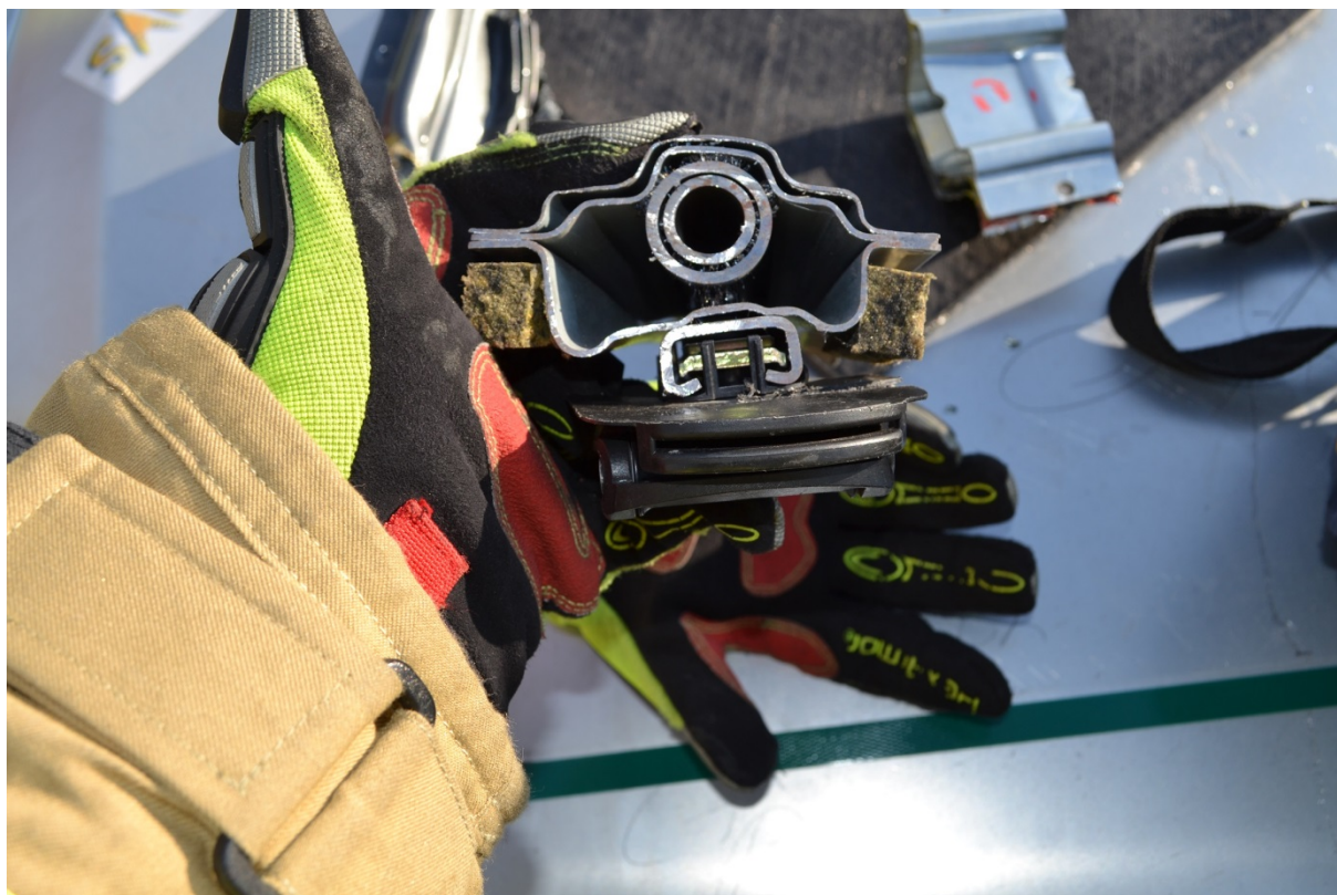
Rys. 58. Wzmocnienie słupka C, które mogłoby uniemożliwić przecięcie nożycami
