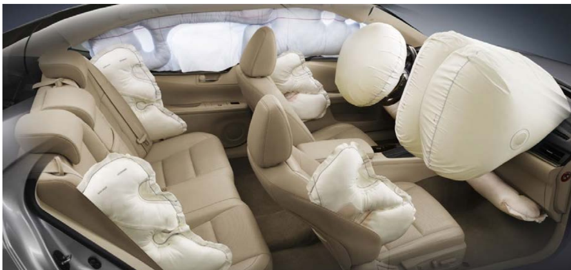
Rys. 62. Przykładowe umiejscowienie poduszek bezpieczeństwa.
