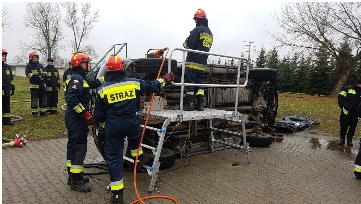
Rys. 466. Platforma ratownicza ułatwiająca pracę na wysokości
