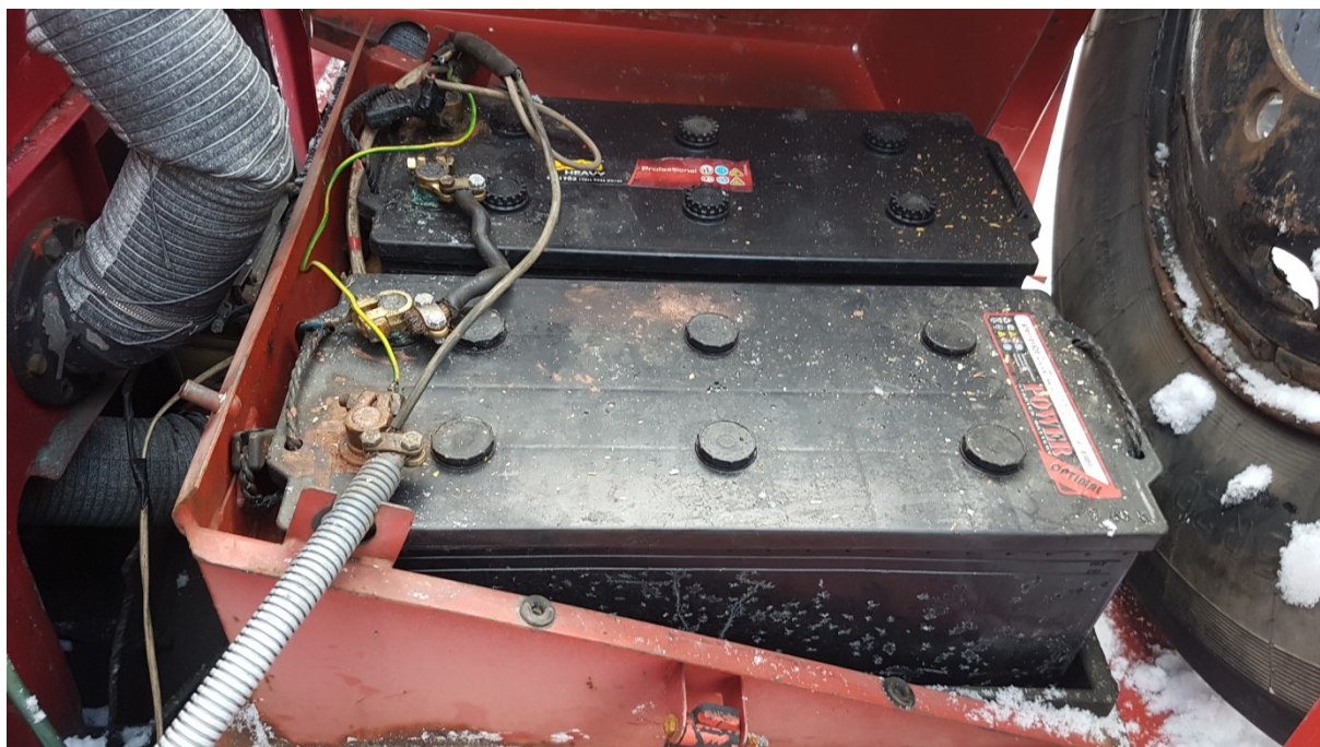
Rys. 92. Akumulatory umieszczone na ramie pojazdu, za kabiną
