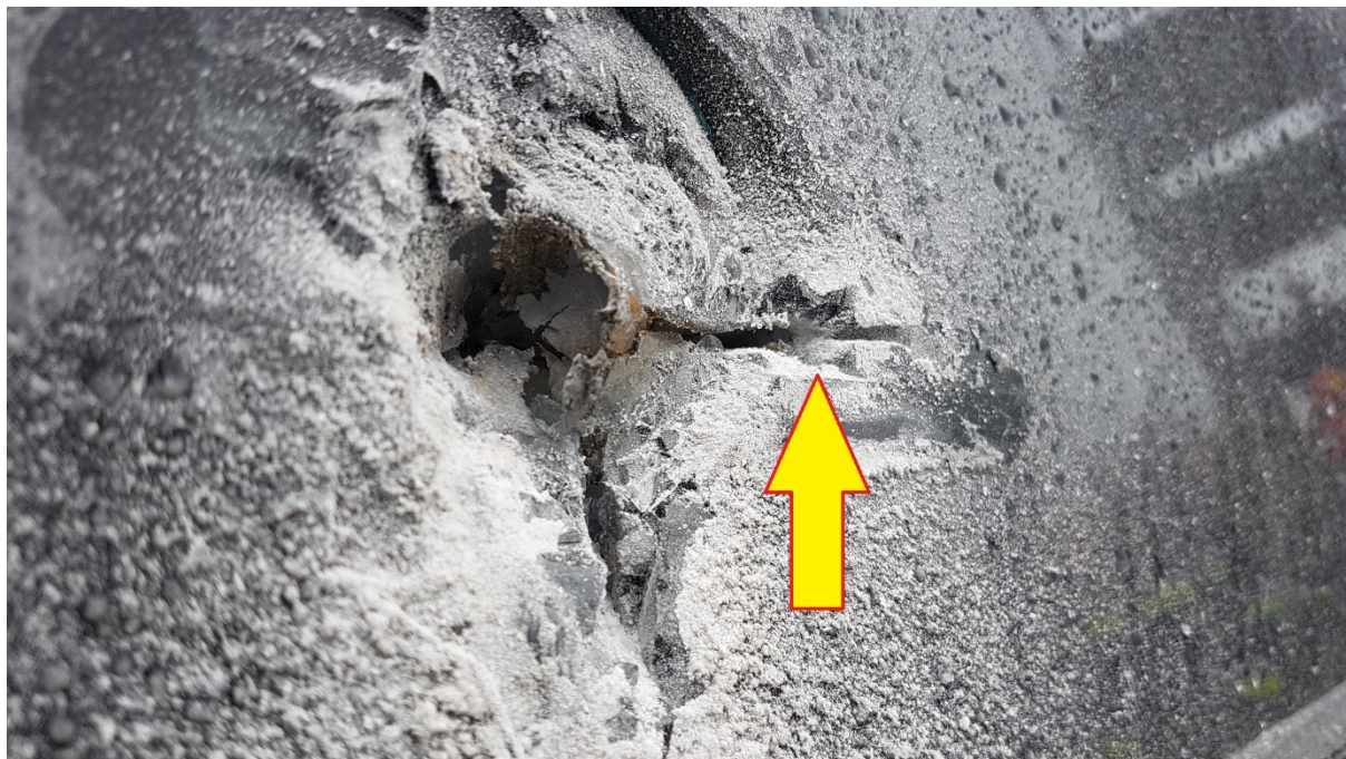
Rys. 463. Niewielkie przecięcie uzyskane przy pomocy piły szablstej
