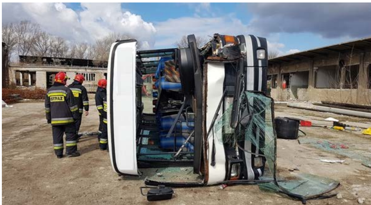
Rys. 417. Dostęp do wnętrza przez przednią szybę
