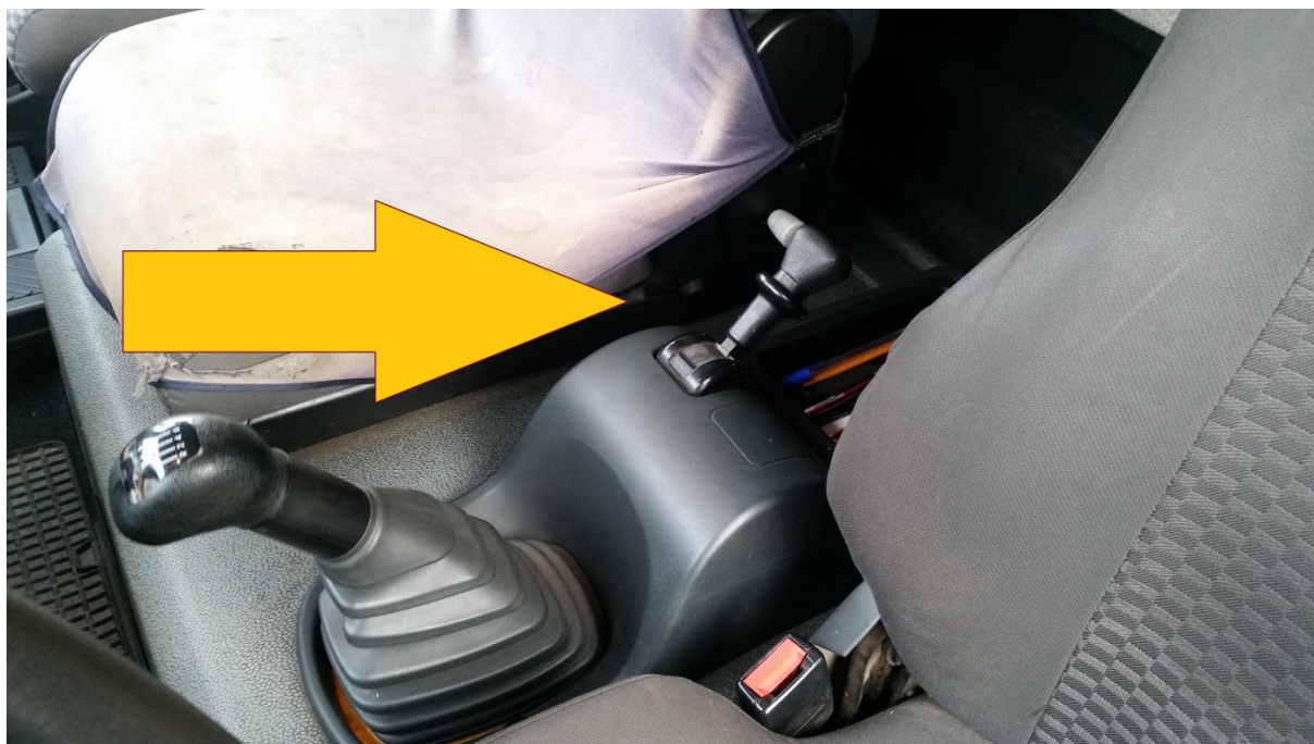
Rys. 102. Dźwignia hamulca postojowego przy drążku zmiany biegów
