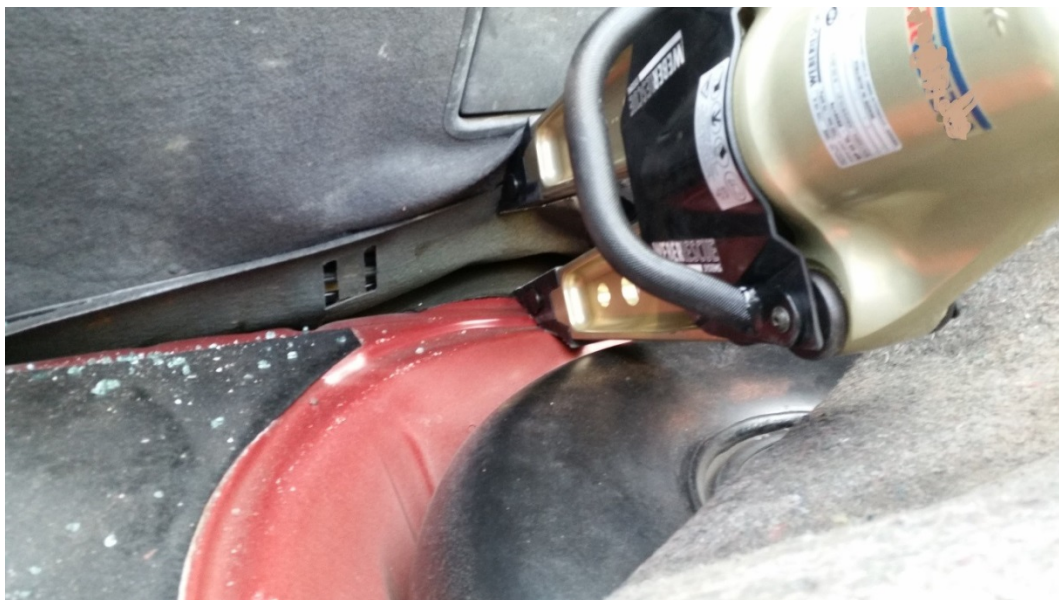
Rys. 278. Zerwanie punktów mocowania oparcia tylnej kanapy
