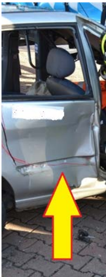
Rys. 271. Metoda „trzecich drzwi”. Cięcie wykonywane piłą szablą
