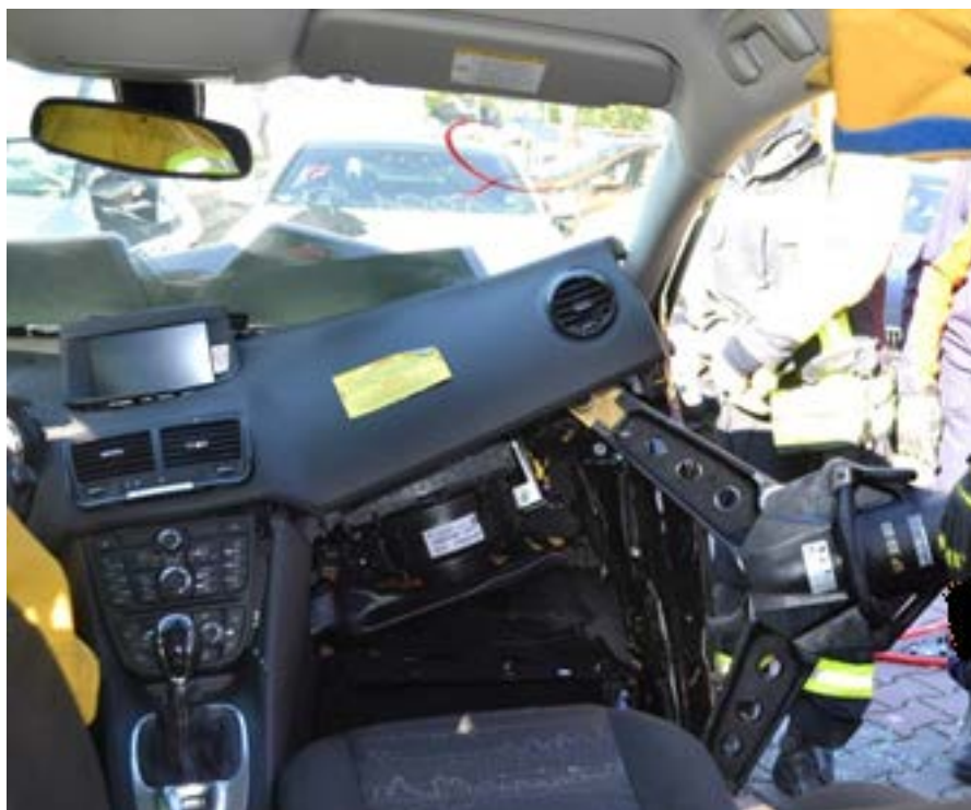
Rys. 203. Wypychanie deski rozdzielczej przy pomocy rozpieracza. Z progu pojazdu muszą być zdjęte lub odchylone gumowe i/lub plastikowe elementy, aby zapobiec wyskoczeniu rozpieracza
