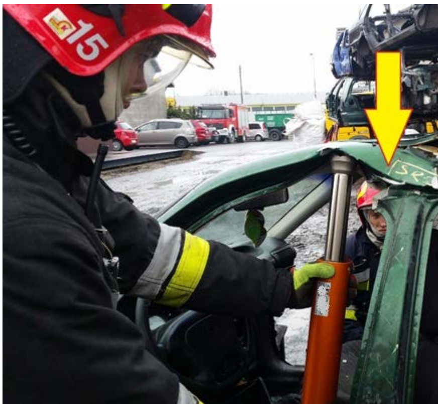
Rys. 262. Rozpoczęcie pęknięcia zgrzewu. Górny punkt osadzenia ok. 2 cm za zaobleniem łączenia słupka
