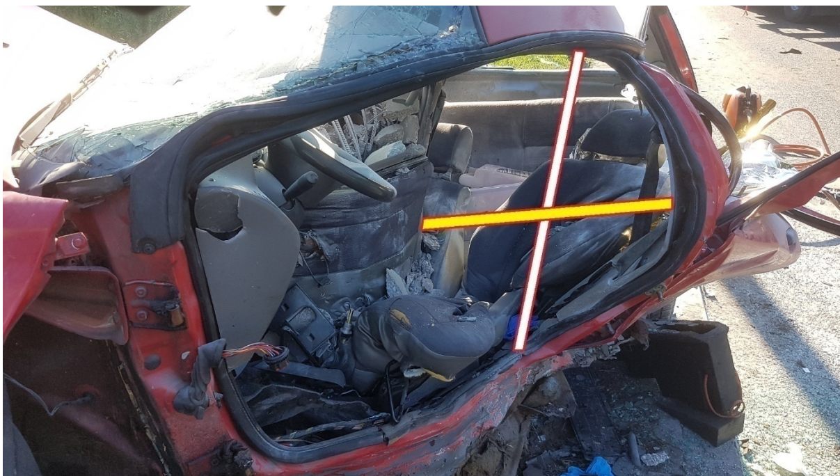
Rys. 235. Sytuacja po rozpieraniu. Biała linia pokazuje, gdzie znajdował się słupek C przed rozpieraniem. Żółta linia pokazuje kierunek rozpierania, które uwolniło miednicę poszkodowanego
