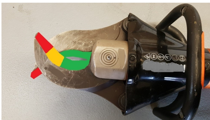
Rys. 4. Podczas zaciskania ostrzy siły w danych punktach wzrastają
