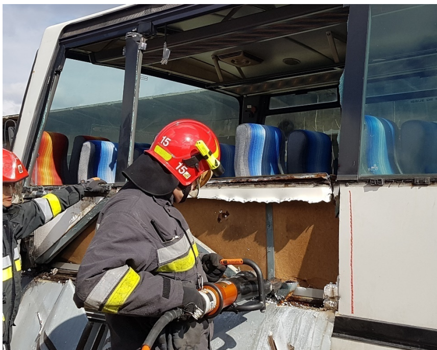
Rys. 404. Cięcie odsoniętych profili nożycami hydraulicznymi
