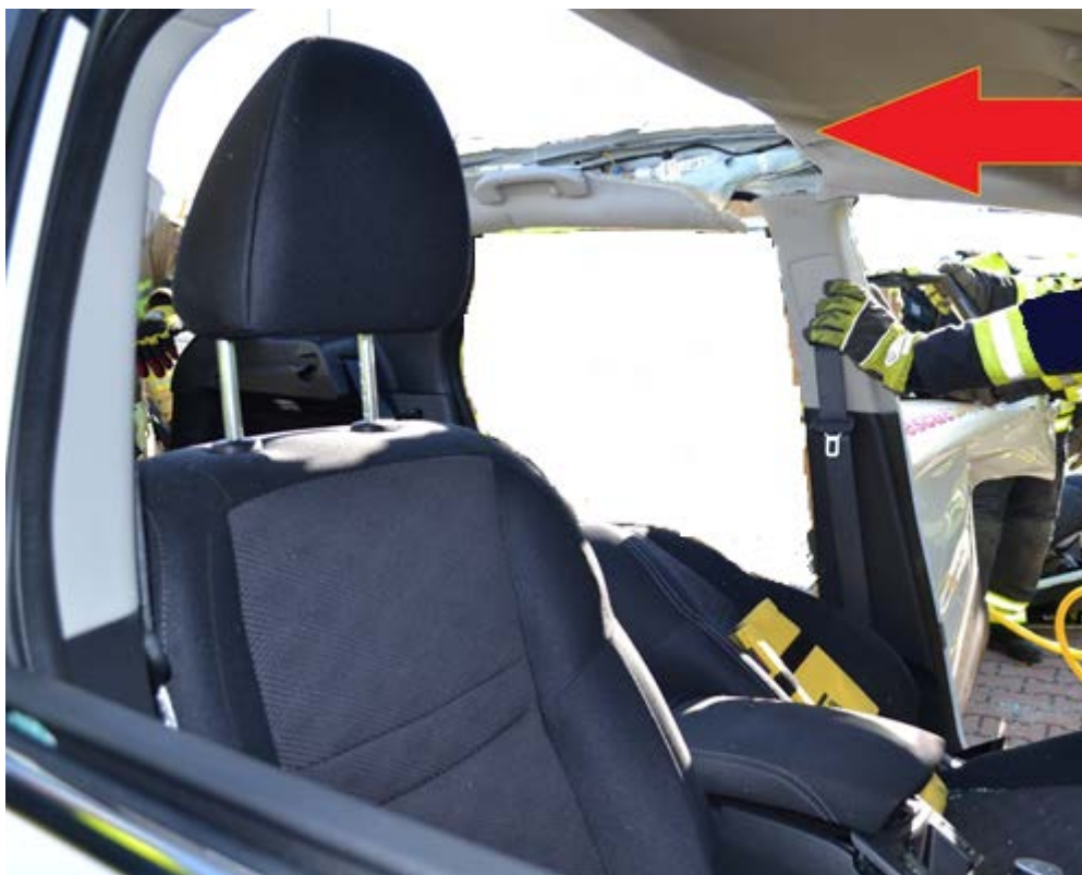
Rys. 264. Uwidocznione w wyniku rozpoznania wewnętrzne umiejscowienie generatora położonego obok słupka C uniemożliwiające użycie cylindra rozpierającego w tym miejscu
