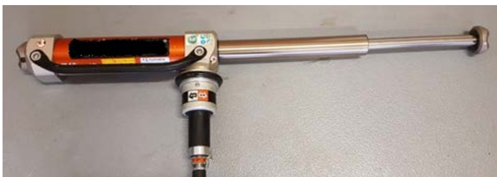
Rys. 18. Cylinder rozpierający teleskopowy dwustopniowy
