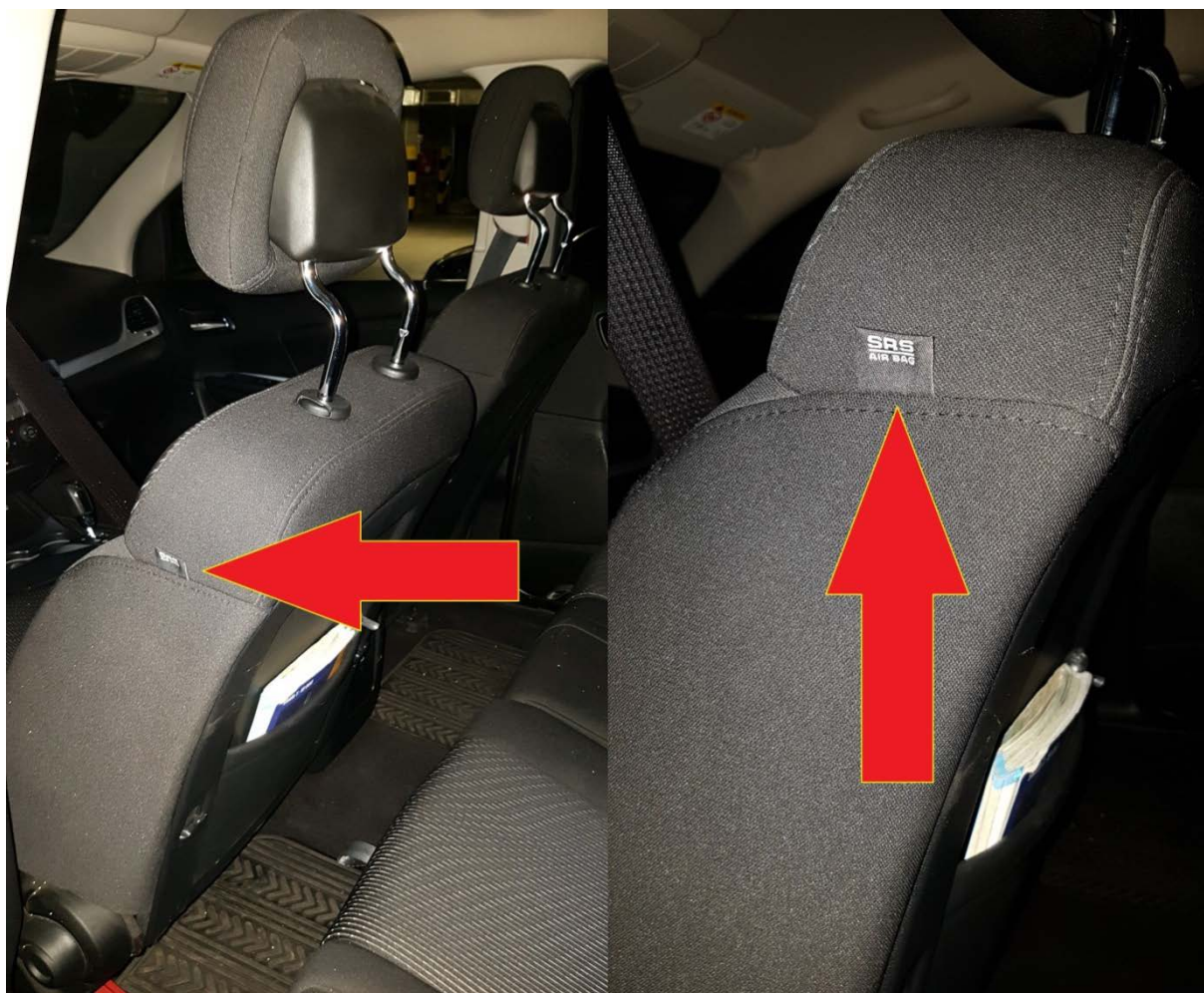
Rys. 141. Umieszczenie elementów systemów bezpieczeństwa w fotelach
