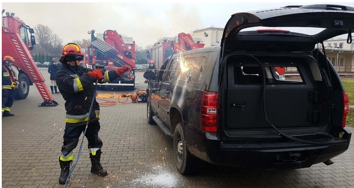
Rys. 464. Nieskuteczna próba przecięcia szyby palnikiem (lancą tlenową)
