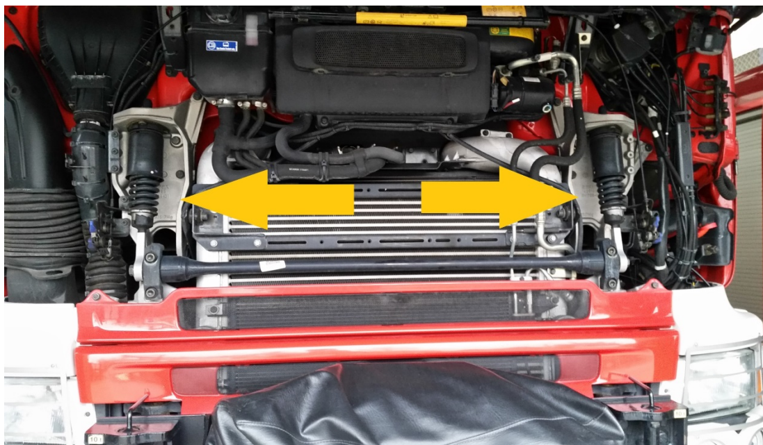
Rys. 88. Amortyzacja kabiny za pomocą sprężyn śrubowych z teleskopowymi amortyzatorami hydraulicznymi (przód)
