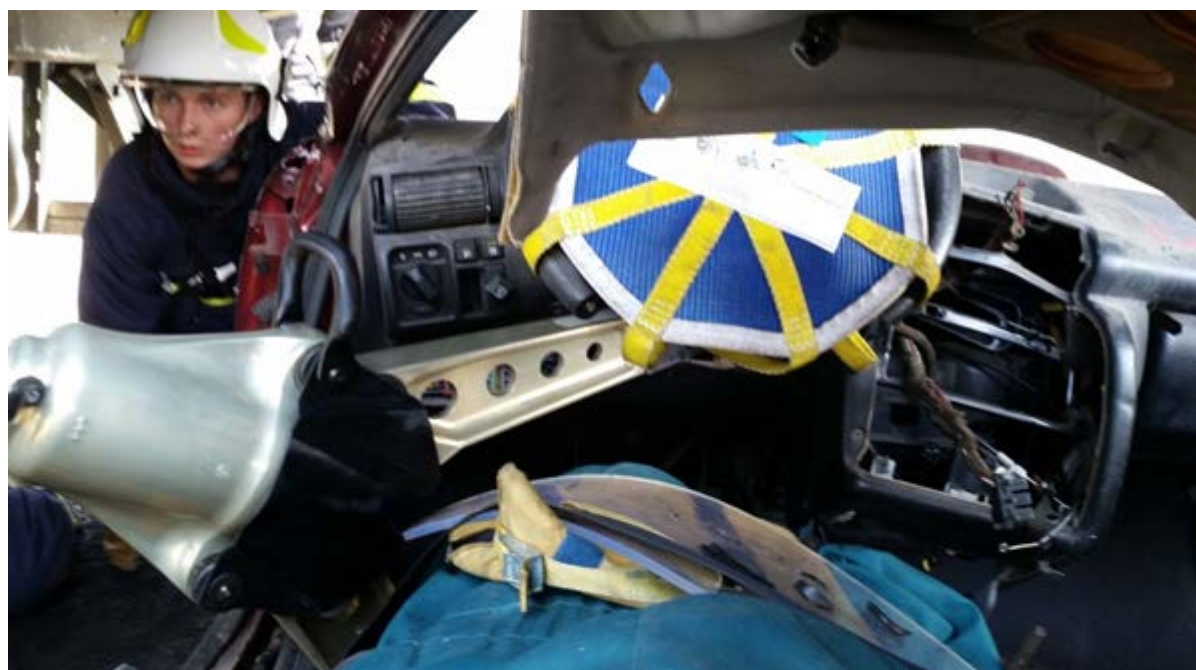
Rys. 196. Podniesienie kolumny kierownicy przy pomocy rozpieracza. Rozpierzacz wyparty o odsłonięty, metalowy próg Uwaga: zdjęcie pokazuje sytuację po zakończeniu ruchu narzędzia. Podczas jego wykonywania wymagany jest pewny uchwyt narzędzia w celu asekuracji
