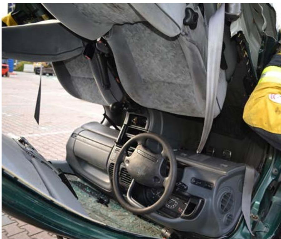
Rys. 319. Szeroki dostęp po usunięciu obu boków pojazdu
