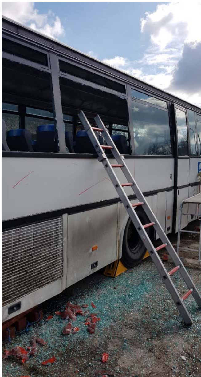
Rys. 399. Przestrzeń uzyskana po usunięciu okna
