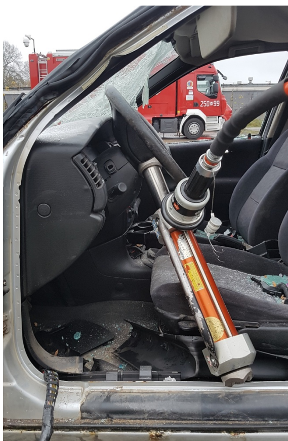
Rys. 201. Wyparcie kolumny kierowniczej przy pomocy cylindra rozpierającego wypartego o metalowy próg pojazdu. Z progu pojazdu muszą być zdjęte lub odchyłone gumowe i/lub plastikowe elementy, aby zapobiec wyskoczeniu cylindra
