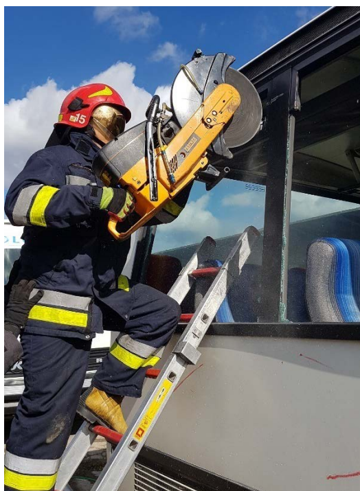
Rys. 410. Wykorzystanie piły spalinowej z tarczą korundową
