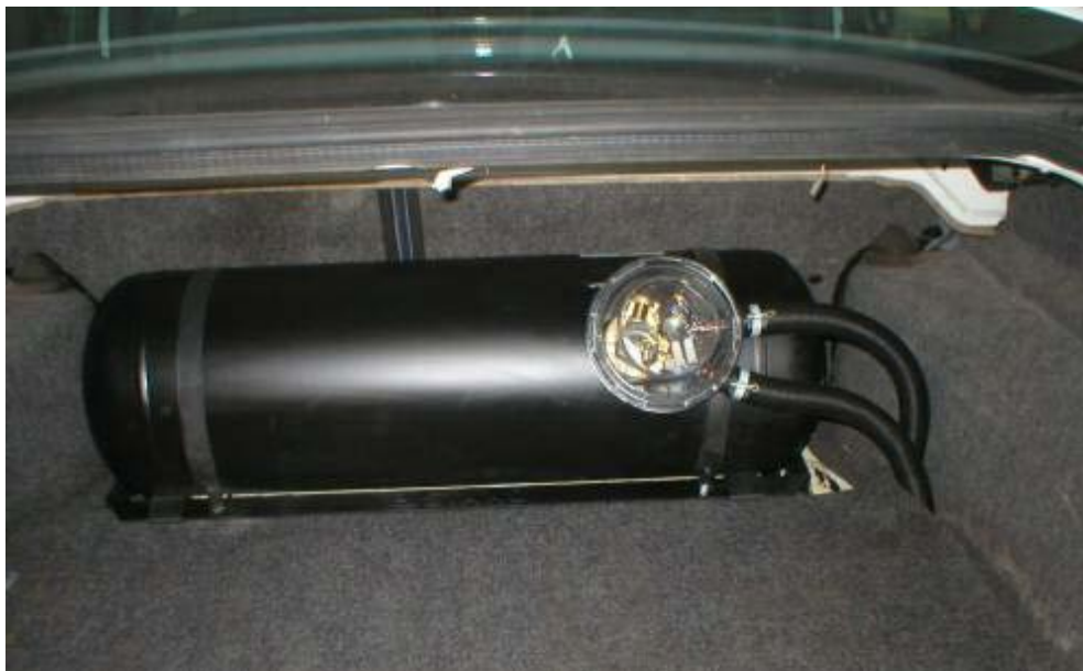
Rys. 71. Zbiornik walcowy, umiejscowiony w bagażniku
