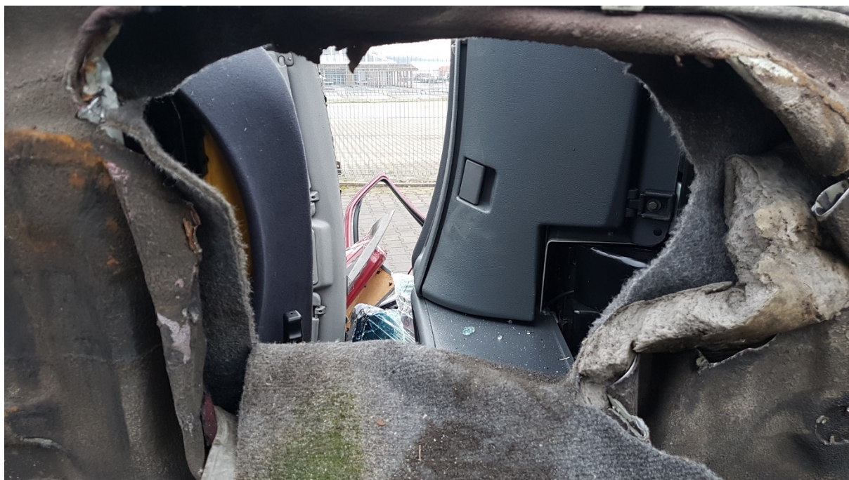
Rys. 223. Jakość wykonanego otworu w podłodze po wykonaniu wycięcia tapicerki i wyjęcia wycieraczki
