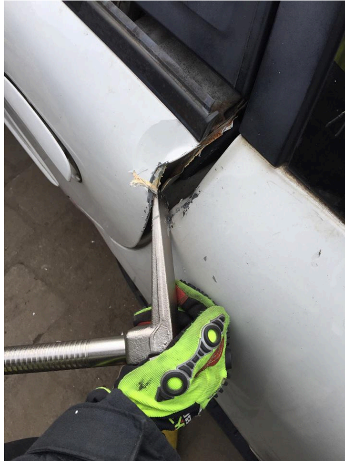
Rys. 246. Dalsze powiększanie szczeliny przez obrót halligana
