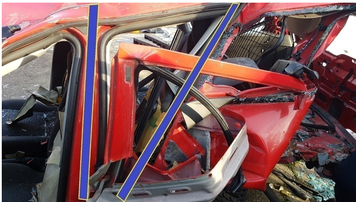
Rys. 237. Pojazd po uderzeniu w tył. Sytuacja przed rozpieraniem. Niebieskie linie pokazują występowanie słupka C i D
