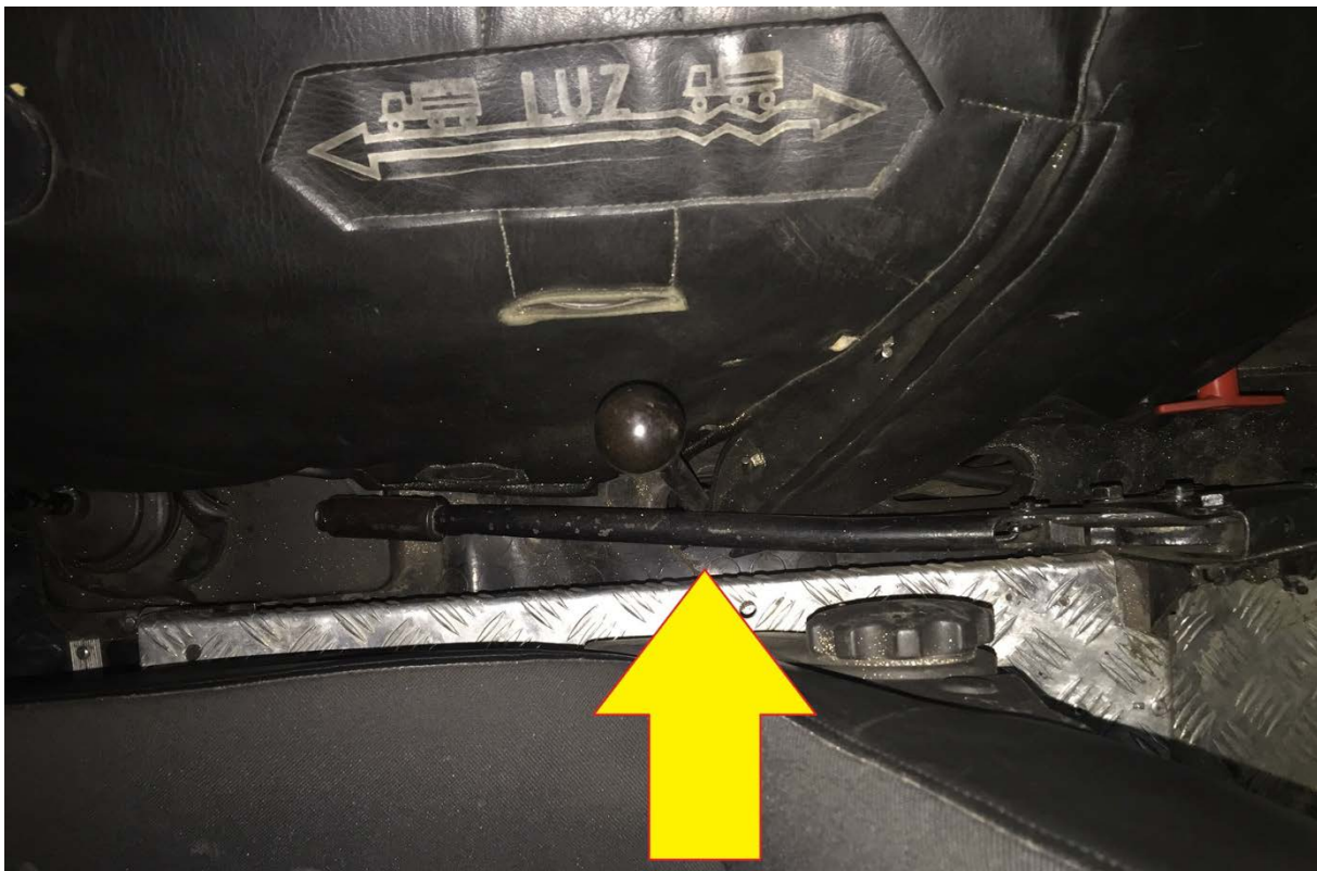
Rys. 101. Drążkowa dźwignia hamulca postojowego
