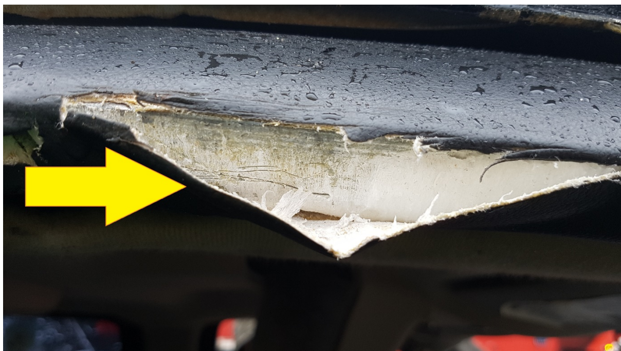
Rys. 450. Wewnętrzny szkielet balistyczny. Strefa podsufitowa
