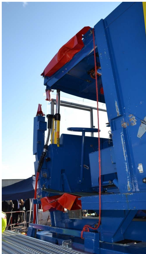
Rys.345. Wypychanie dachu kabiny przy pomocy cylindra rozpierającego
