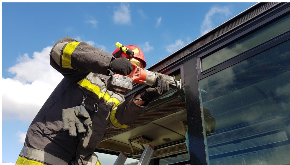
Rys. 407. Cięcie profili okiennych piłą szablą
