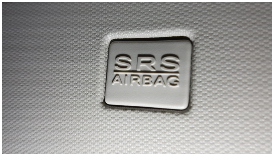
Rys. 64. Oznaczenie miejsca występowania poduszki bezpieczeństwa
