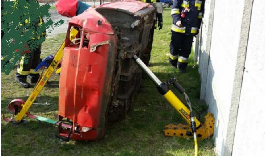
Rys. 295. Wykorzystanie cylindra rozpierającego, jako elementu stabilizacji. Tu wspornik nieumocowany pasem do podwozia, ze względu na jego zakotwienie o pewny, betonowy płót
