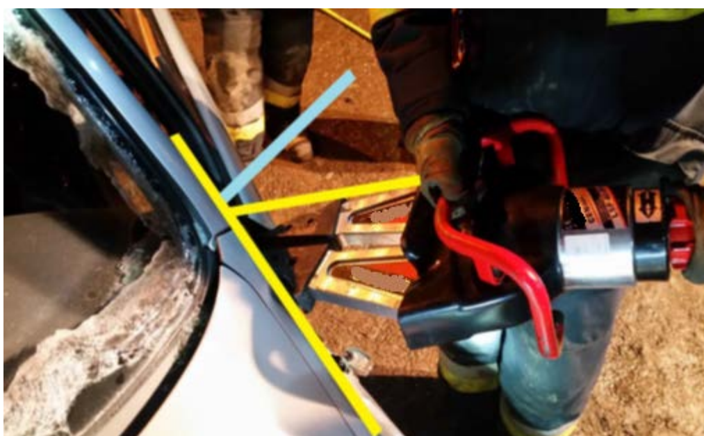
Rys. 13. Prawidłowe ustawienie rozpieracza pod kątem 45 stopni do wrywanego elementu. Jedno ramię wrywa drzwi, drugie tworzy podstawę, o którą opiera się rozpieracz
