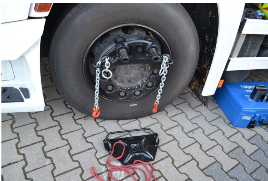
Rys.380. Specjalna końcówka montowana na feldze wypukłej
