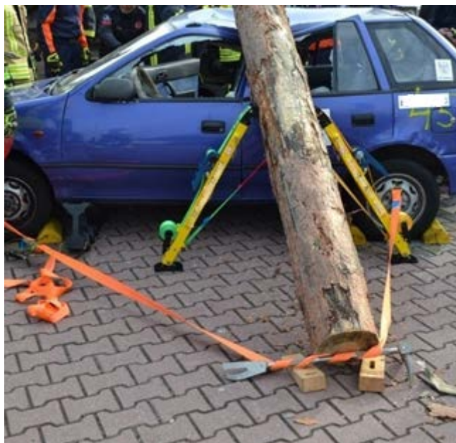
Rys. 320. Stabilizacja auta oraz elementu, który go przygniótł (dla lepszej stabilizacji użyto również halligana)
