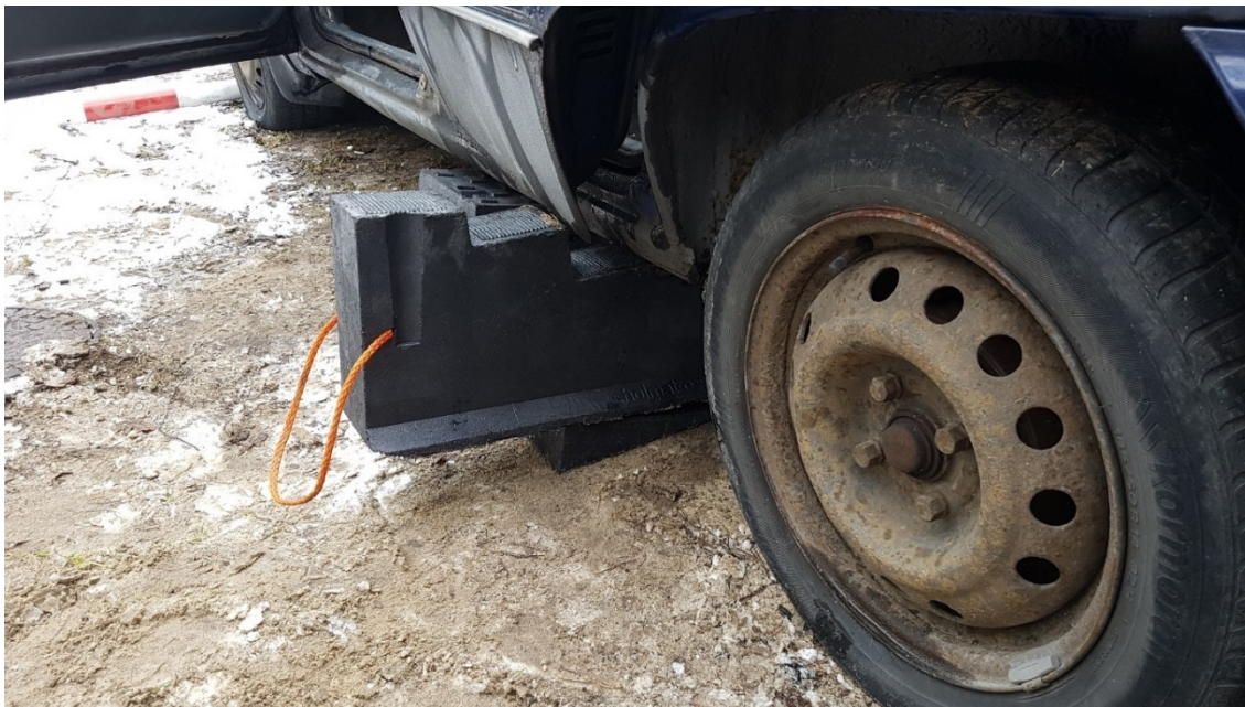
Rys. 149. Ograniczenie sposobu: głębokie wsuwanie dolnego klina pod klinem schodkowym przy szybkim podnoszeniu się wraku na resorowaniu
