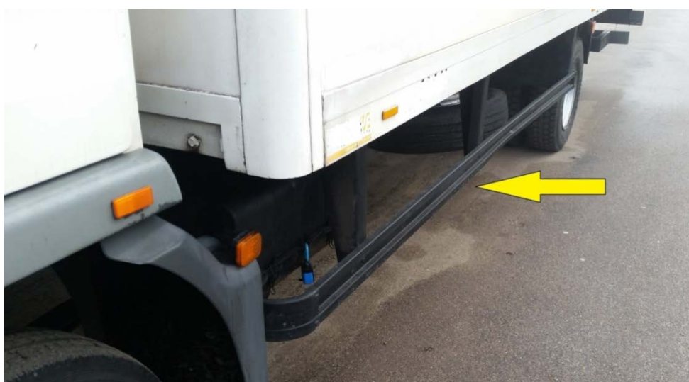
Rys. 90. Kompatybilność wymiarowa samochodu osobowego i ciężarowego zapewniona przez zderzaki montowane w samochodzie ciężarowym
