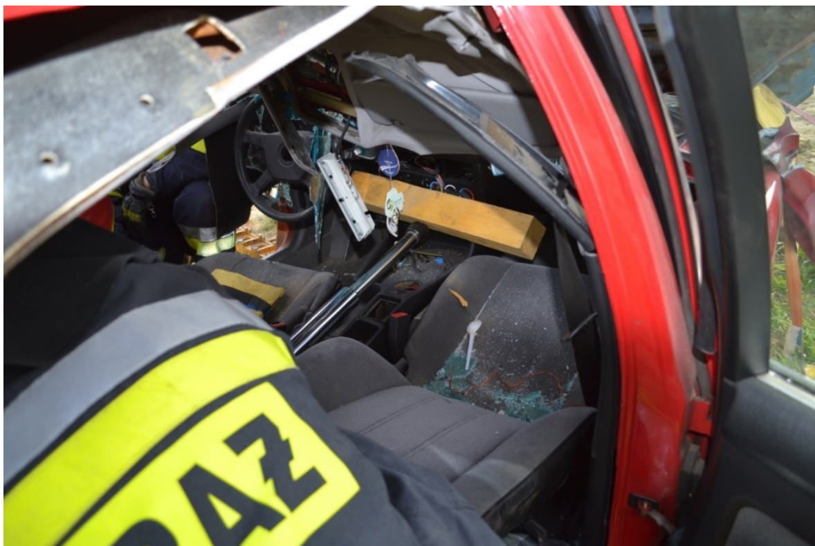
Rys. 206. Sytuacja po drugiej stronie cylindra rozpierającego. Siła cylindra rozprowadzona na całą deskę rozdzielczą przy pomocy drewnianej deski kantowej
