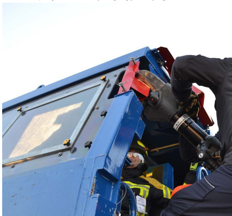
Rys. 341. Nacięcie słupka A równoległe do jego przekroju
