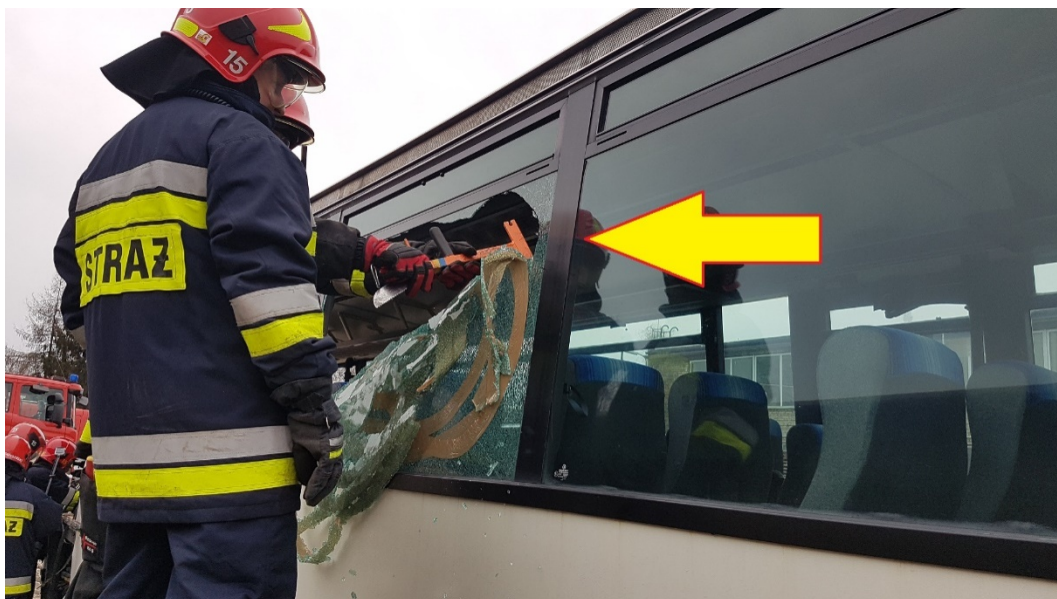
Rys. 395. Dokładne oklejenie szyb pozwala usunąć rozbite szkło na zewnątrz pojazdu
