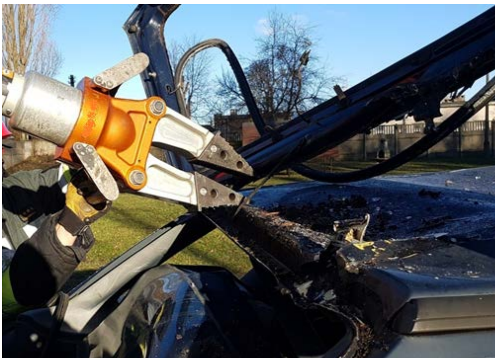
Rys. 277. Całkowite oderwanie klapy bagażnika przy pomocy rozpieracza
