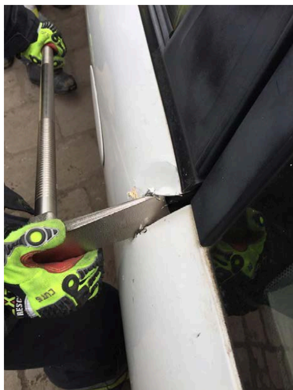
Rys. 245 A, B. Powiększanie szczeliny przez obrót narzędzia
