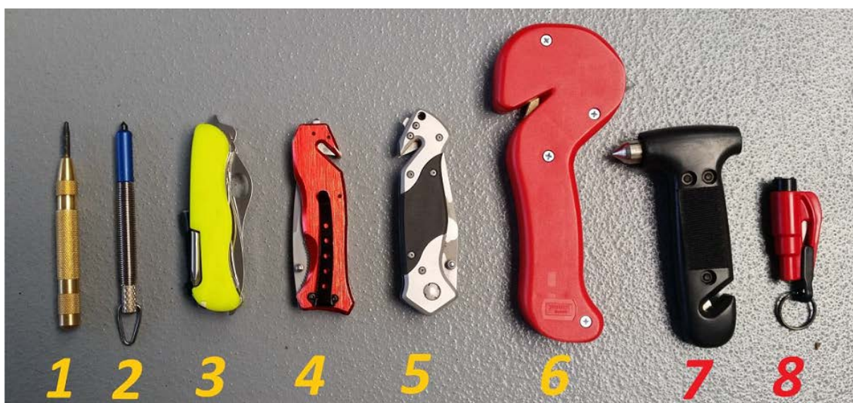
1. Zbijak-punktak. 2. Zbijak sprężynowy. 3. Profesjonalny nóż ratowniczy. 4. i 5. Tanie noże ratownicze. 6. i 7. Młotki. 8. Brelok
