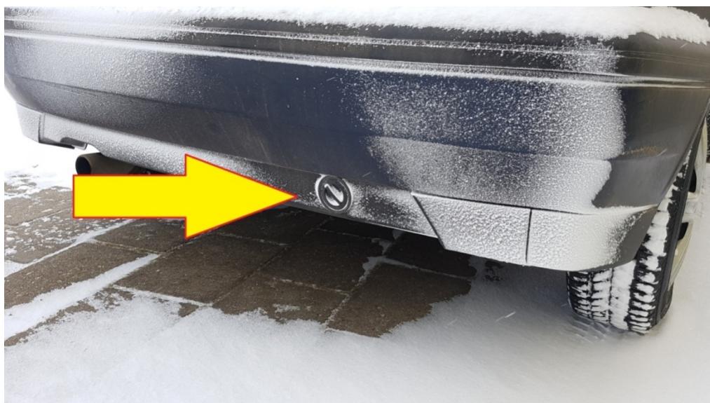
Rys. 72. Umiejscowienie króćca wlewowego gazu z tyłu pojazdu
