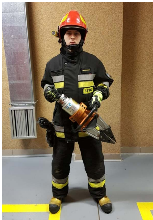
Rys. 35. Trzymanie manetki rozpieracza podchwytem, które utrzymuje prawidłowy kąt pracy narzędzia
