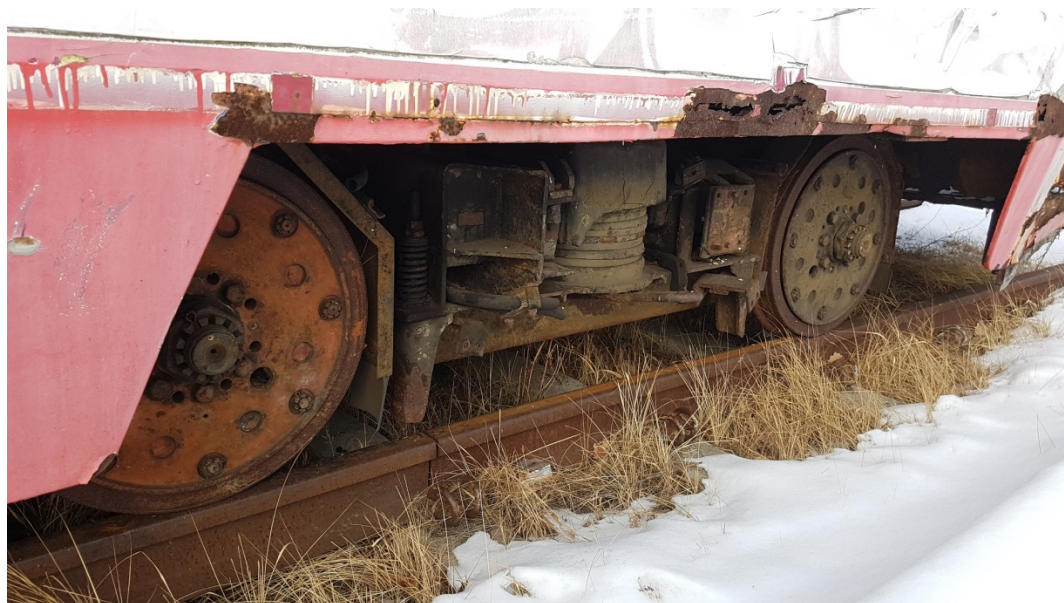
Rys. 113. Wózek jezdny tramwaju
