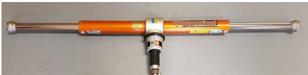
Rys. 17. Cylinder rozpierający dwutłokowy
