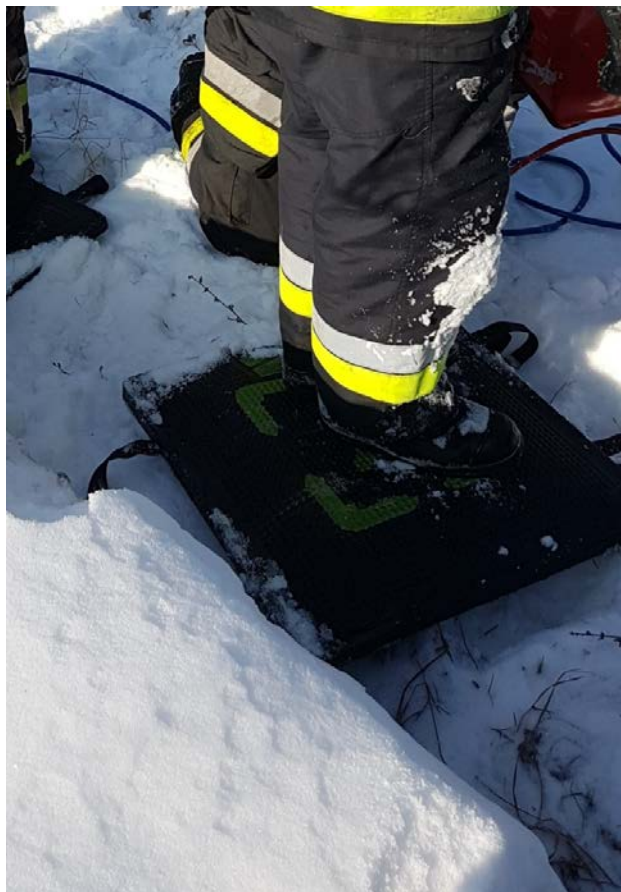
Rys. 49. Prezentacja dużej stabilności poduszki podnoszącej płaskiej
