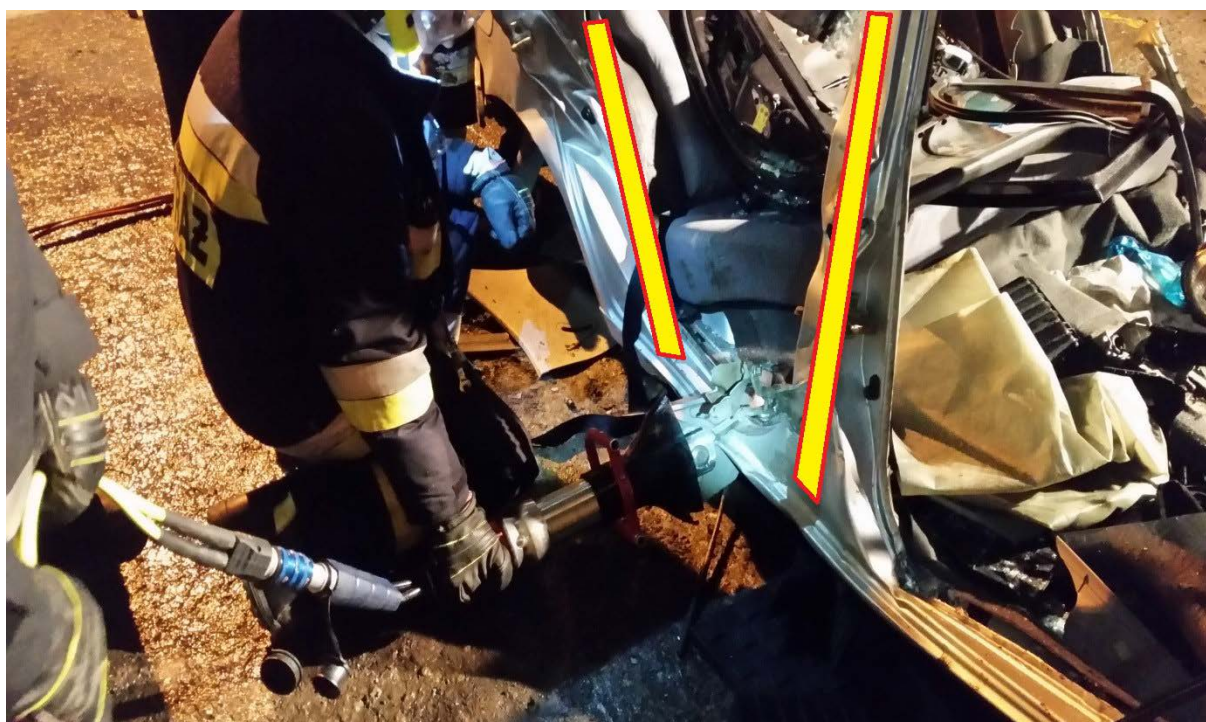
Rys. 239. Pojazd po uderzeniu w tył. Sytuacja przed rozpieraniem. Żółte linie pokazują występowanie słupka C i D. Wykonanie cięcia odpężającego w progu
