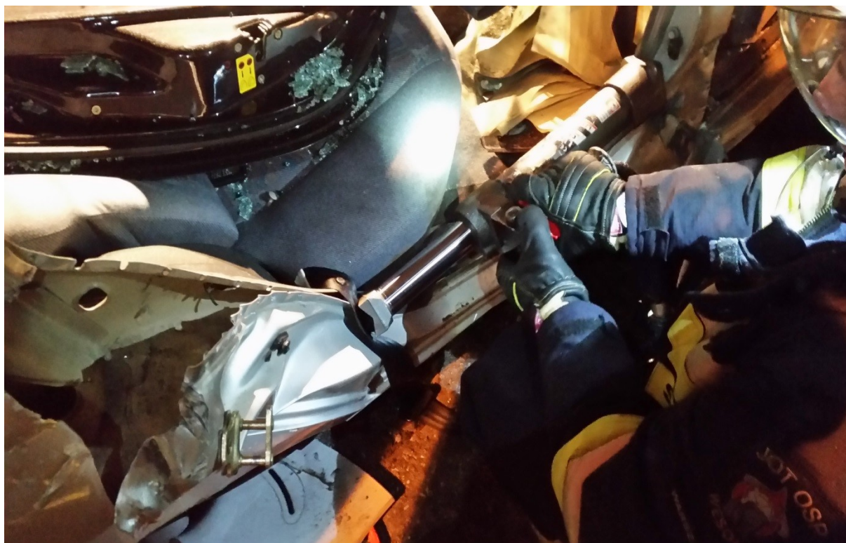
Rys. 240. Dalsze rozpieranie cylindrem rozpierającym
