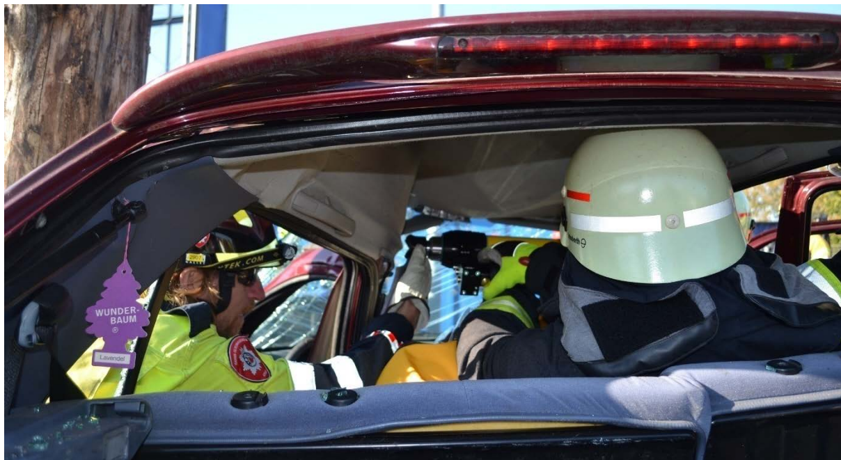
Rys. 226. Uderzenie boczne z drzewem. Rozpoczęcie cross-ramming
