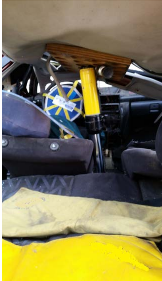
Rys. 357. Uzyskanie przestrzeni wokół osoby poszkodowanej przy pomocy techniki cross-ramming
