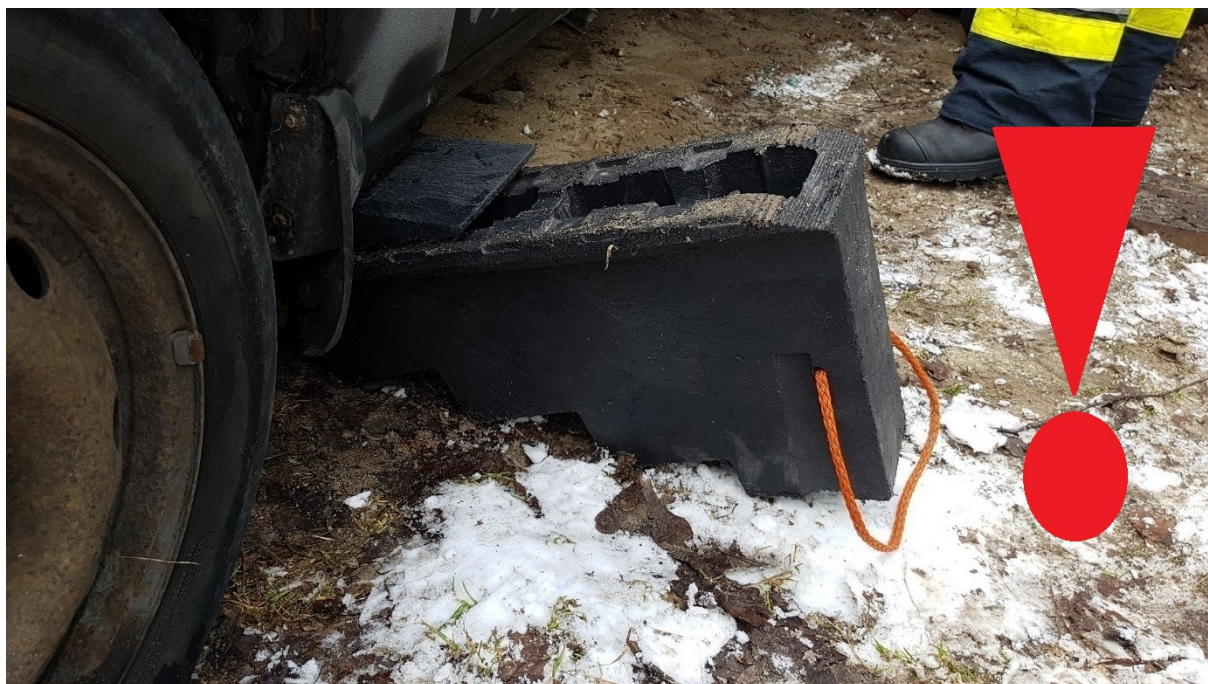
Rys. 152. Ograniczenie sposobu: po zdemontowaniu taśmy technicznej traci się możliwość skutecznego poprawienia sztywności układu
