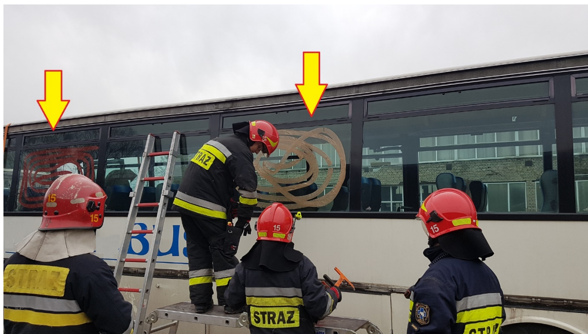
Rys. 394. Dokładne oklejenie szyb. Praca z podestu ratowniczego
