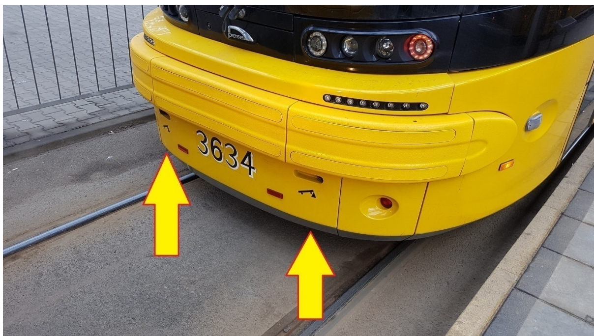
Rys. 430. Zaznaczone punkty do podnoszenia wagonu
