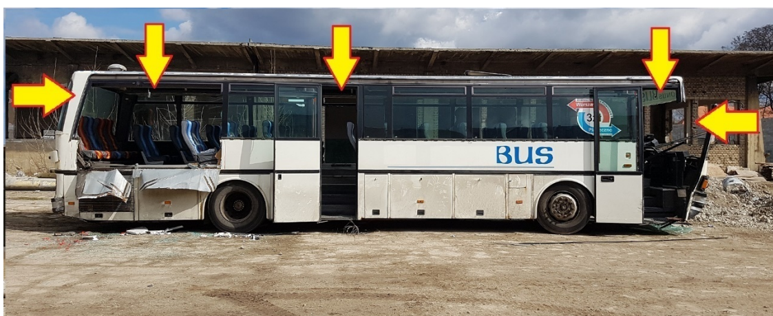
Rys. 393. Autobus na kołach. Możliwe wejścia: drzwiami, przednią i tylną szybą, dodatkowym otworem (wybite okno, wycięty bok)
