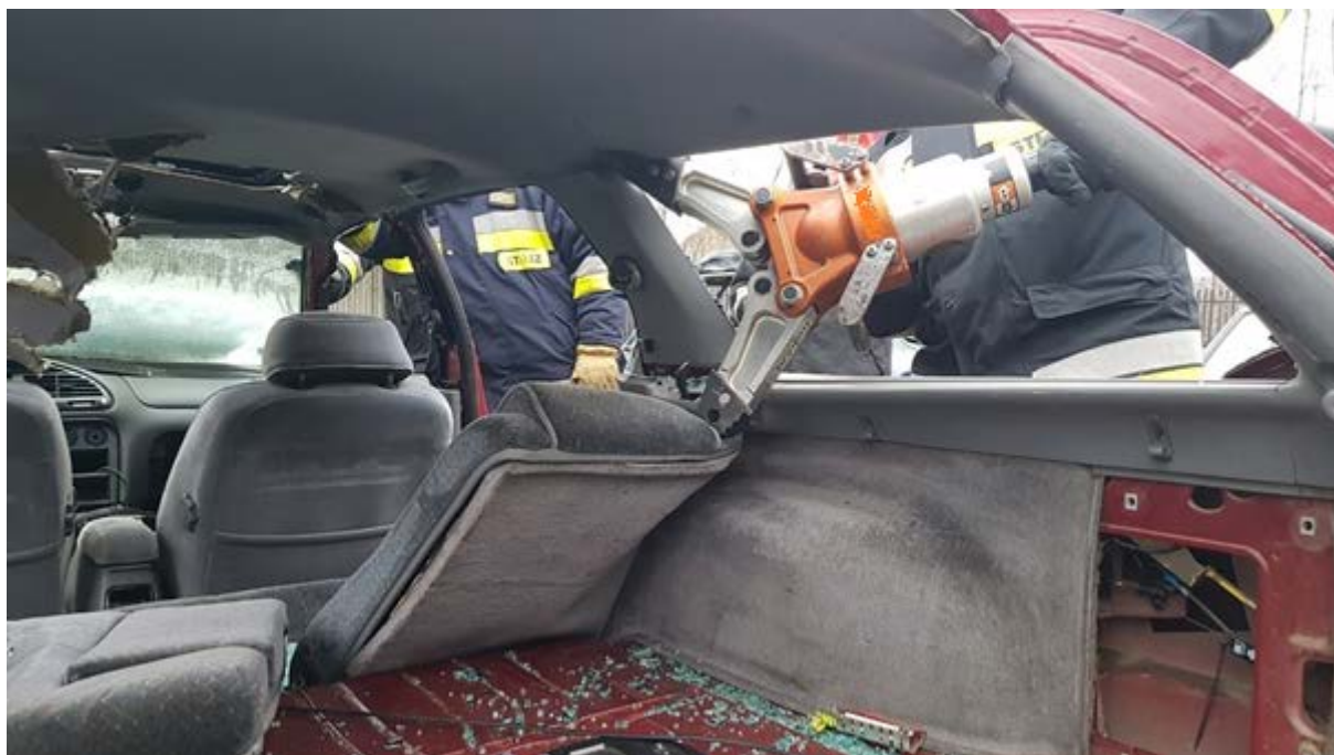
Rys. 282. Siłowe opuszczenie tylnego oparcia rozpieraczem od zewnątrz auta. Tu niewymagana podbudowa dachu, ze względu na wyparcie o mocną podłużnicę
