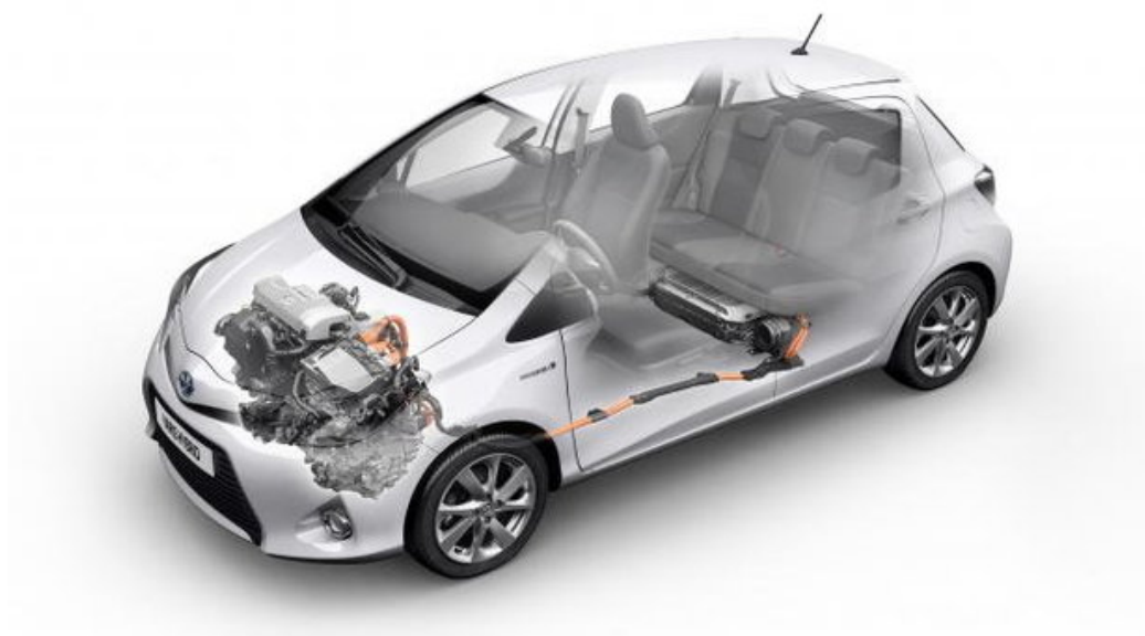
Rys. 78. Układ hybrydowy na przykładzie Toyoty Prius
