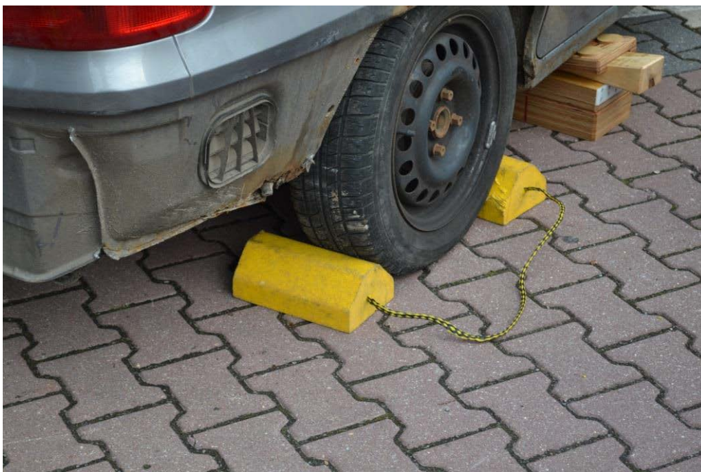
Rys. 157. Zabezpieczenie przed toczeniem wykonane na jednym kole przy pomocy prostego urządzenia – przejrzysta kontrola prawidłowości wykonania
