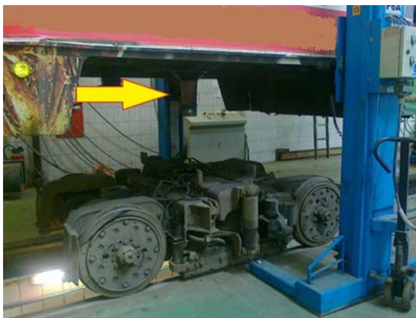
Rys. 426. Wózek jezdny i sworzeń wagonu Źródło: Jacek Gawroński, SA PSP Poznań
