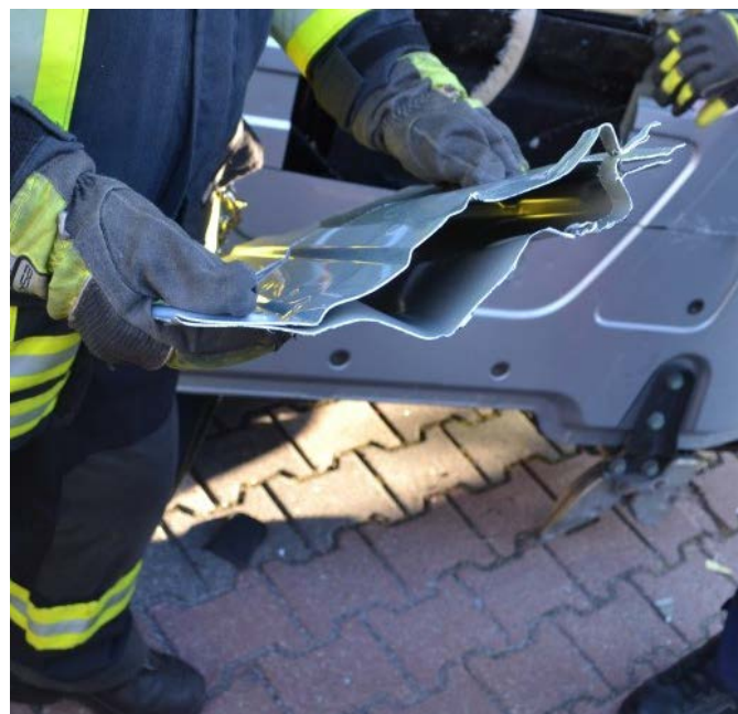
Rys. 350. Przekrój przez wypukłe elementy ściany kabiny
