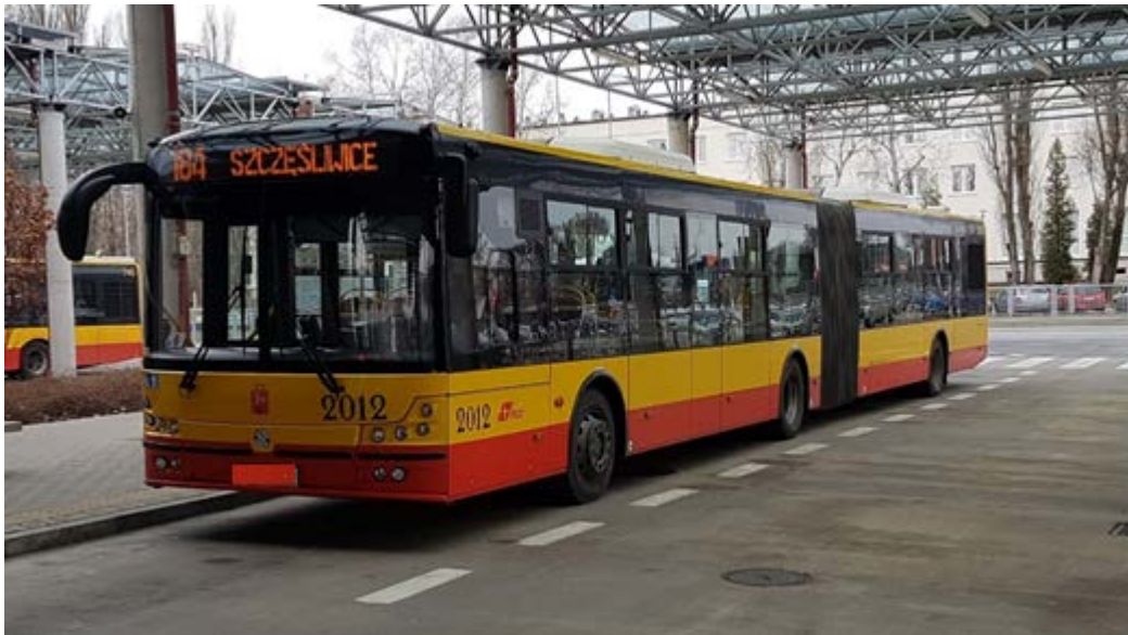
Rys. 108. Autobus przegubowy, trzyosiowy
