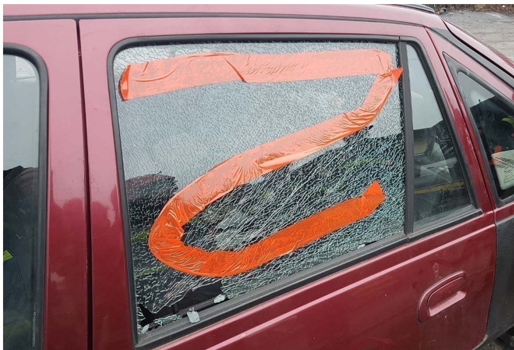
Rys. 186. Nawet niedokładne oklejenie szyby utrzymuje szkło w ryzach. Występuje tu jednak trudność w późniejszym wypychaniu rozbitego szkła na zewnątrz pojazdu
