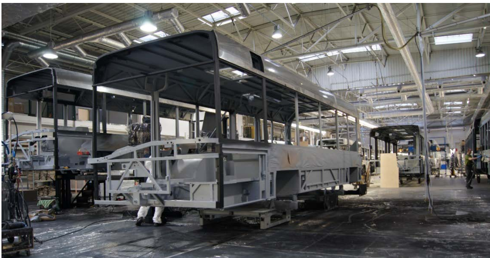
Rys. 105. Nadwozie samonośne autobusu Źródło: Jacek Gawroński SA PSP Poznań
