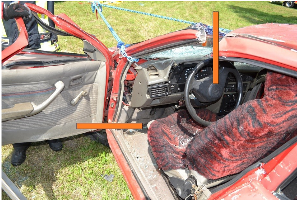
Rys. 442. Miejsca cięć słupka A i B po wyważeniu: zaraz przy dachu oraz u podstawy, nad progiem. Cięcia po obu stronach pojazdu
