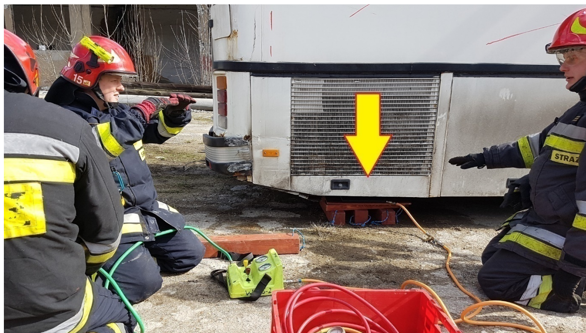
Rys. 425. Podnoszenie autobusu sprzętem pneumatycznym
