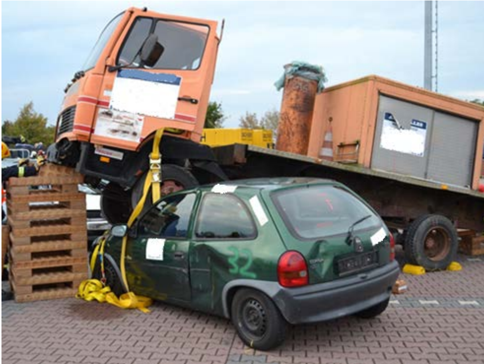
Rys. 371. Trzy pasy: jeden stabilizuje kabinę, drugi resorowanie ciężarówki, a trzeci resorowanie osobówki
