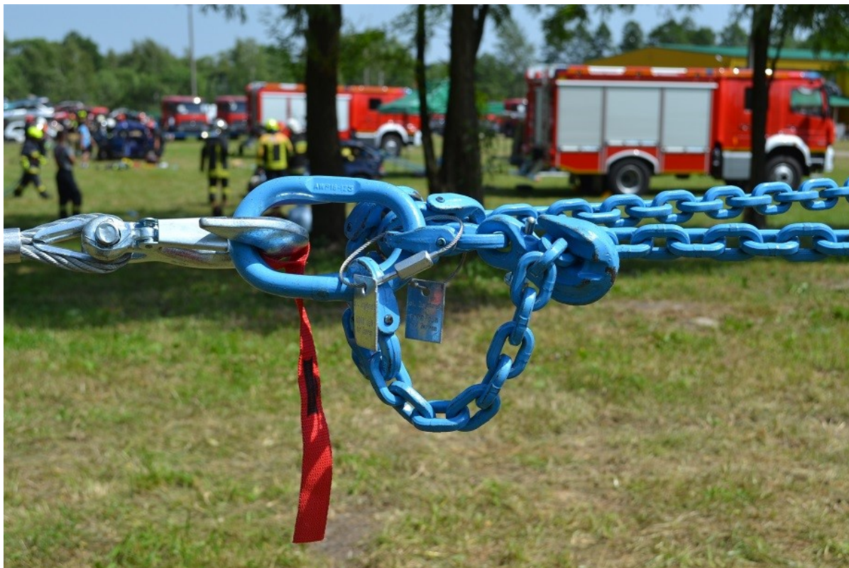
Rys. 437. Zastosowanie łańcuchów, które umożliwiają regulację ich długości
