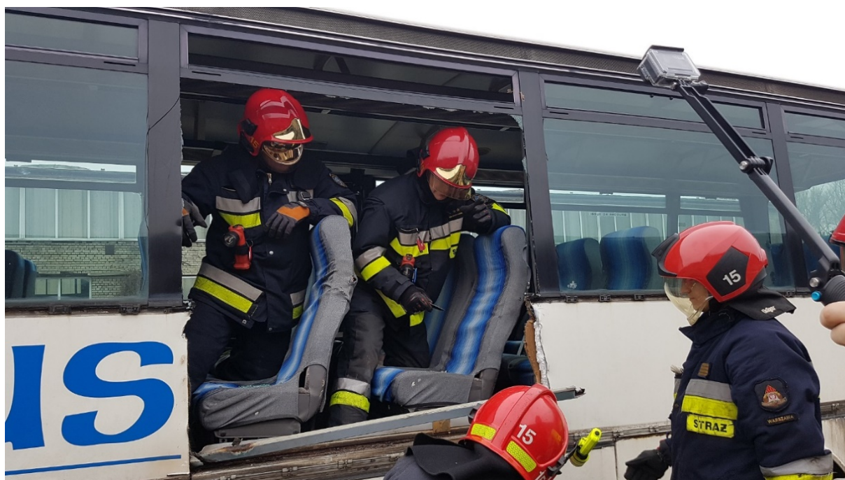
Rys. 400. Przestrzeń uzyskana po usunięciu boku o szerokości jednego okna
