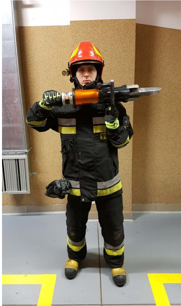
Rys. 34. Trzymanie narzędzia przy podwyższonej pracy narzędzia
