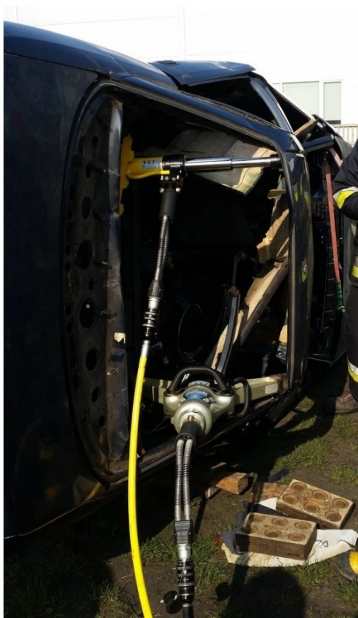
Rys. 298. Poszerzenie przestrzeni do ewakuacji poprzez wyparcie dachu od strony bagażnika przy pomocy rozpieracza i cylindra rozpierającego
