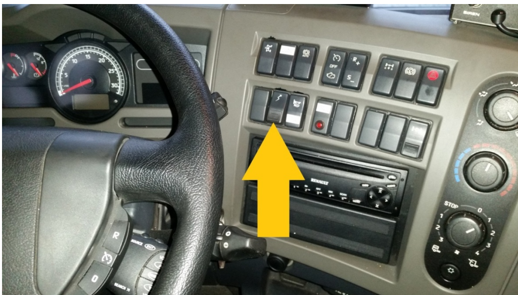
Rys. 94. Główny wyłącznik prądu umieszczony na desce rozdzielczej
