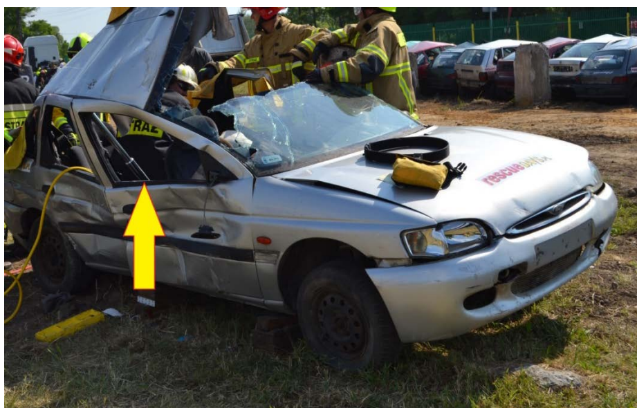
Rys. 259. Odgięcie dachu ku górze przy pomocy cylindra rozpierającego
