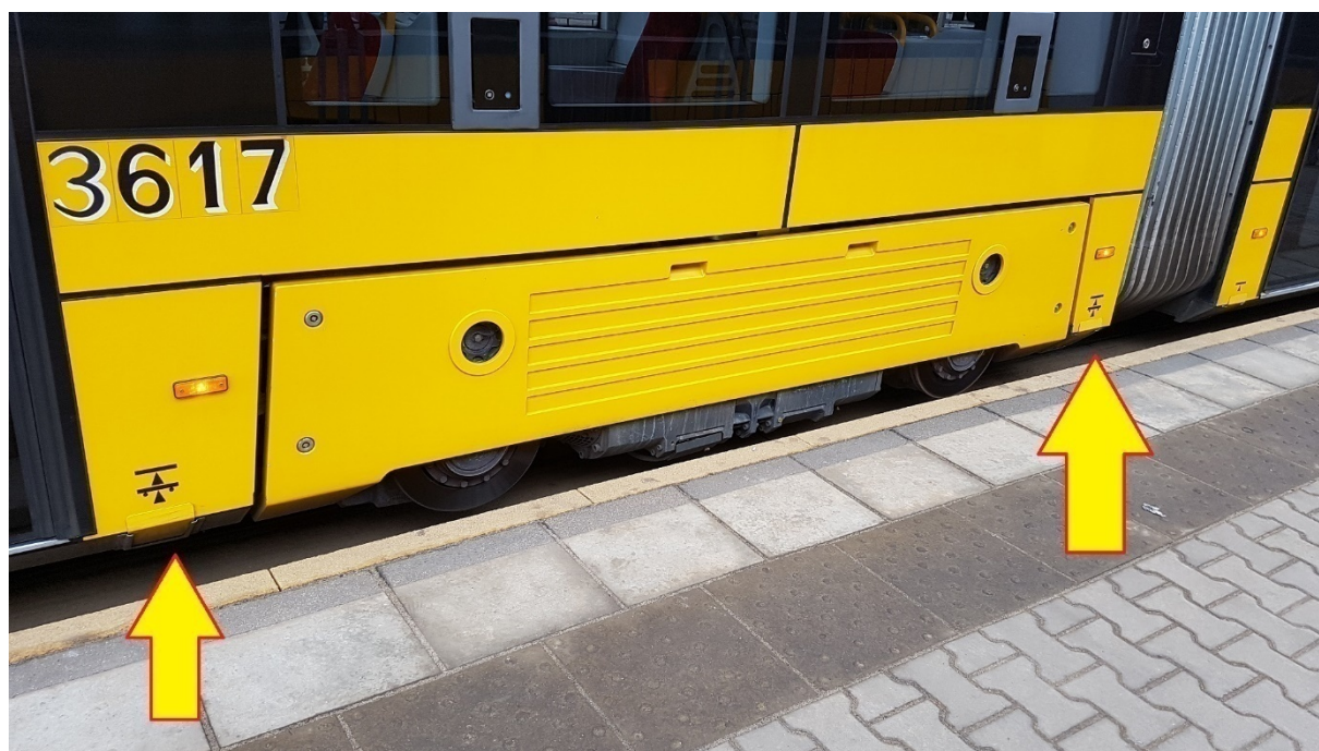
Rys. 428. Zaznaczone punkty do podnoszenia wagonu
