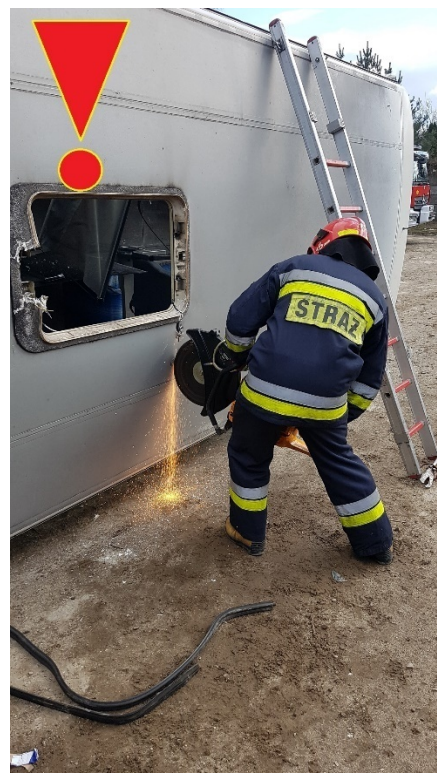
Rys. 418. Tworzenie dostępu do wnętrza przez wyłaz dachowy
