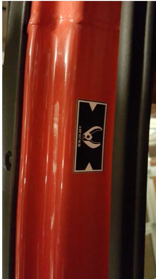
Rys. 136. Oznaczona strefa bezpiecznego cięcia słupka
