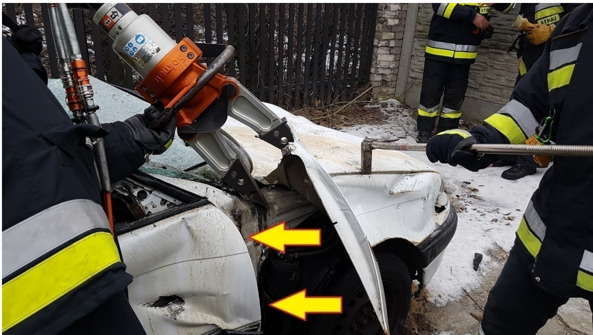
Rys. 248. Zdjęcie nadkola dające możliwość rozpoznania sytuacji pod spodem, ujawnienia miejsc, które należy przeciąć w niektórych technikach dostępu do nóg osób poszkodowanych oraz dające dostęp do zawiasów przednich drzwi
