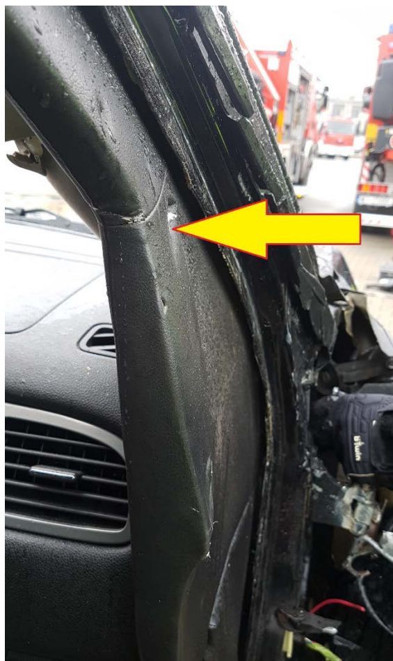
Rys. 451. Wewnętrzny szkielet balistyczny. Okolice słupka A
