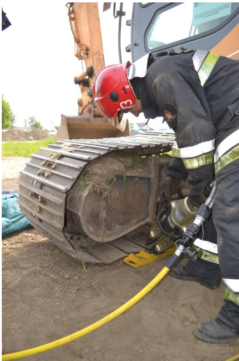
Rys. 387. Rozpieranie samej gąsienicy
