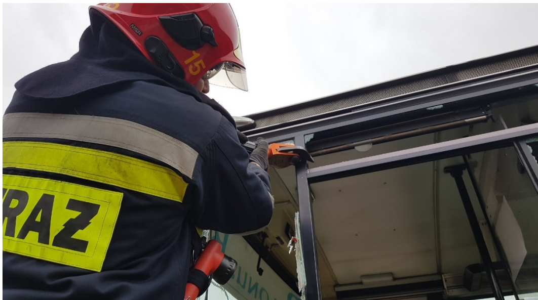
Rys. 405. Cięcie drobnych profili okiennych przy pomocy mini-nożyc
